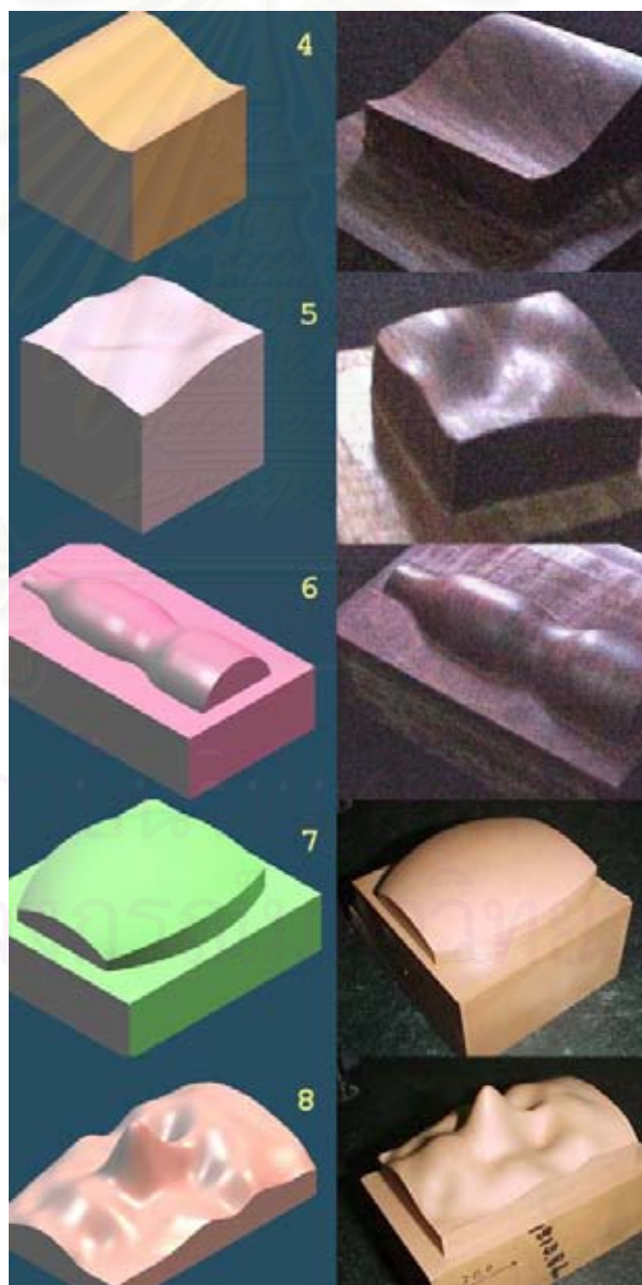
รูปที่ 5.4 แบบชิ้นงานที่ 4 ถึง 8 เปรียบเทียบกับแบบจำลองที่วาด
