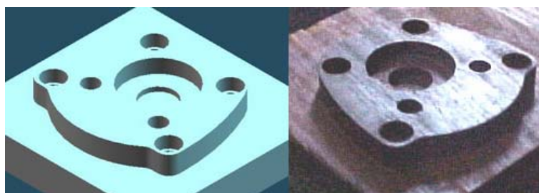
รูปที่ 5.1 แบบจำลองชิ้นที่ 1 กับชิ้นงานจริงที่กัดได้
