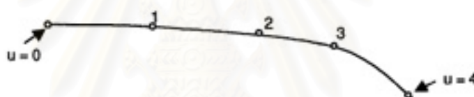
รูปที่ 2.9 เส้นโค้งยูนิฟอร์ม บี-สไปไลน์
