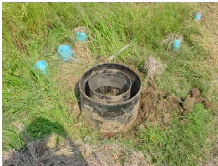
รูปที่ ๑-10 การวางถังวัดอัตราการซึมลงในพื้นที่ที่เปิดหน้าดินแล้ว โดยให้ Rings ทั้งสองวางซ้อนกัน
