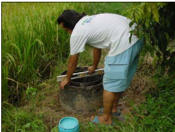
รูปที่ ๑-12 การใช้เครื่องมือวัดระดับน้ำวัดระดับด้านบนของถังวัดอัตราการซึมให้ได้ระดับเดียวกัน
