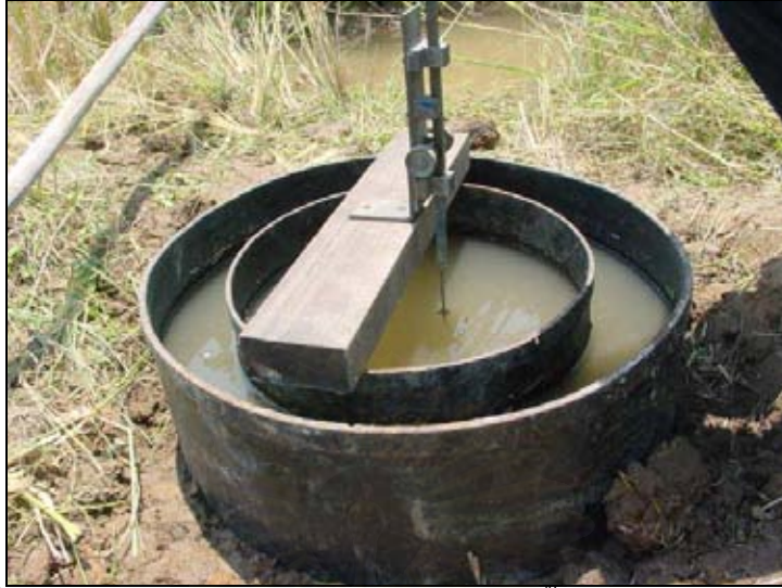
รูปที่ ๑-5 Hook gauge ใช้สำหรับอ่านค่าของระดับน้ำในถังวัดอัตราการซึมน้ำ
