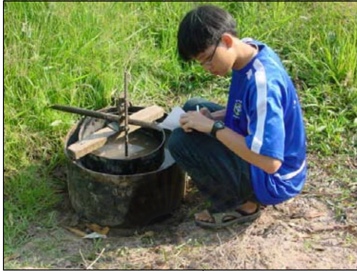
รูปที่ ๑-16 การอ่านค่าจาก Hook gauge เมื่อเวลาผ่านไป 1 นาที และบันทึกผล
