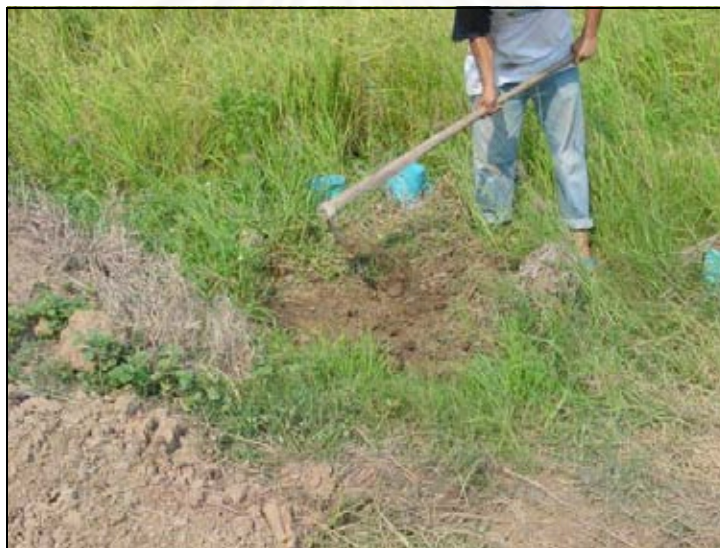
รูปที่ ๑-9 การเปิดหน้าดินเพื่อเตรียมติดตั้งอุปกรณ์การทดลองหาค่าการซึมน้ำผ่านผิวดิน
