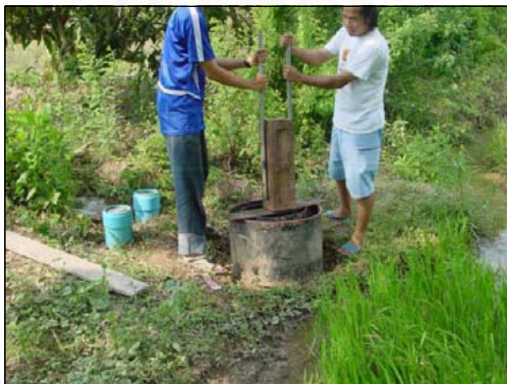
รูปที่ ๑-11 การใช้ท่อน้ำหนักกดลงแผ่นเหล็กให้ถังวัดอัตราการซึมจมลงไปในดิน
