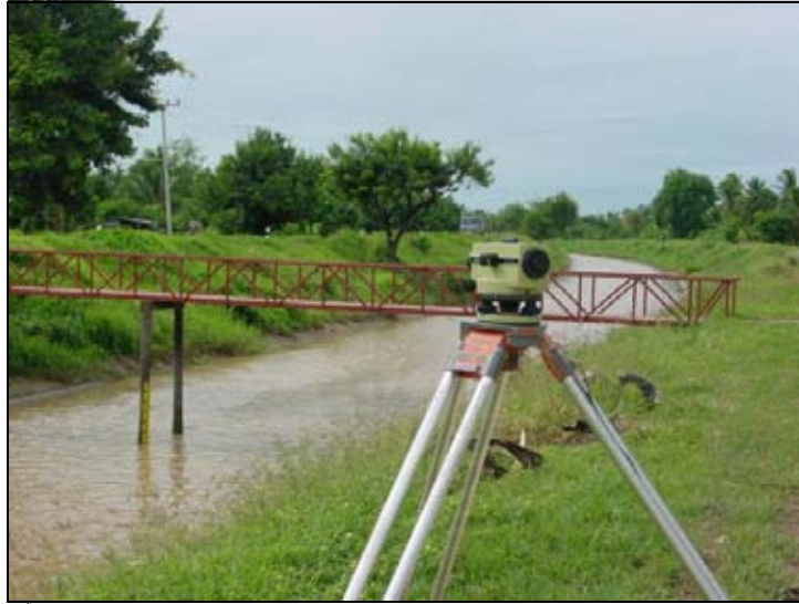
รูปที่ ง-10 การใช้กล้องระดับทำแนวระดับของหน้าตัดการไหลคลองส่งน้ำ
