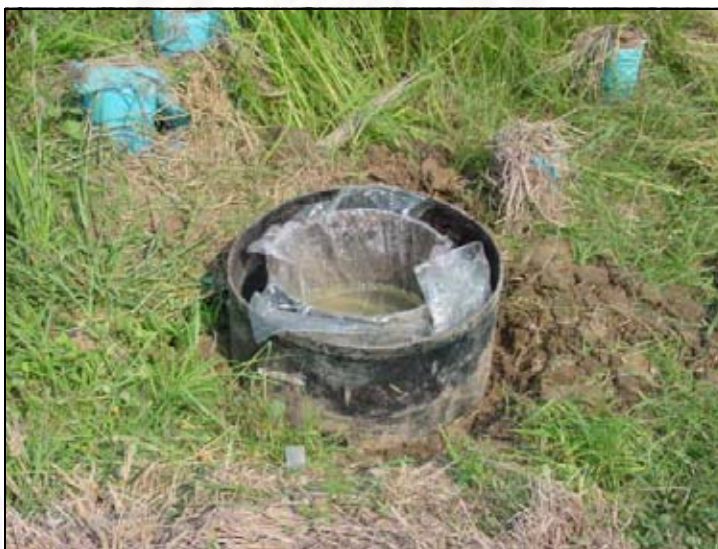
รูปที่ ๑-13 การวางแผ่นพลาสติกในถังวัดอัตราการซึมให้สามารถขังน้ำอยู่ได้
