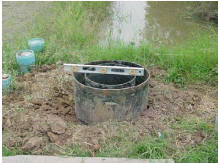
รูปที่ ๑-8 เครื่องมือวัดระดับน้ำ ใช้วัดระดับ Rings ของถังวัดอัตราการซึมน้ำให้ได้ระดับ
