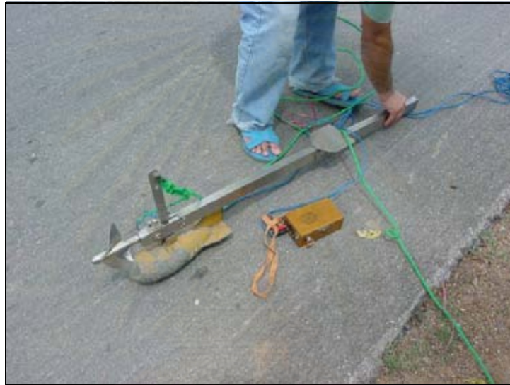
รูปที่ ง-4 เครื่องมือวัดความเร็วการไหลแบบใบจักร (Propeller-type current meter)
