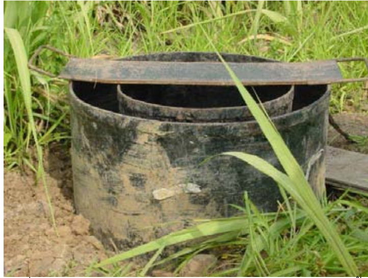
รูปที่ ๑-7 แผ่นเหล็ก ใช้สำหรับรองด้านบนของถังวัดอัตราการซึมน้ำ
