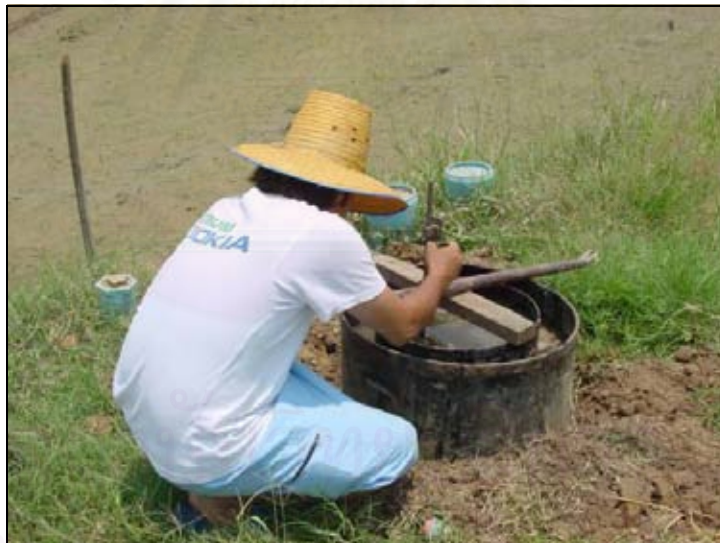
รูปที่ ๑-15 การติดตั้ง Hook gauge ด้านบนของถังและเลื่อนตำแหน่งของสเกลวัดไปที่จุดศูนย์
