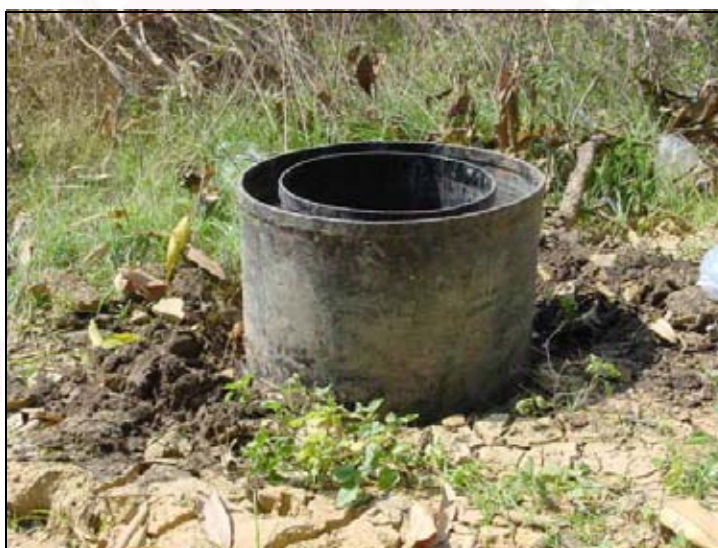
รูปที่ ๑-4 อุปกรณ์ชุดถังวัดอัตราการซึมน้ำ (Double Rings)
