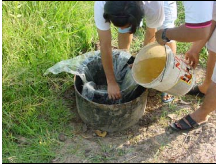
รูปที่ ๑-14 การใส่น้ำสะอาดลงในถังวัดอัตราการซึม
