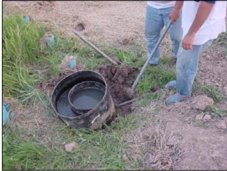
รูปที่ ๑-17 การใช้จอบหรือเสียมงัดถังวัดอัตราการซึมออกจากดิน
