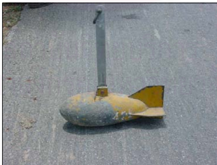
รูปที่ ง-5 ท่อน้ำหนักหรือ ตอปิโด ใช้ถ่วงน้ำหนักของเครื่องมือวัดความเร็วการไหลให้อยู่ในแนวระดับ
