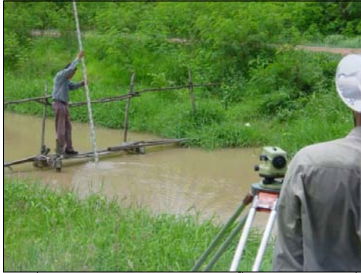
รูปที่ ง-12 การใช้ไม้ระดับวัดความลึกของน้ำตามระยะตำแหน่งที่กำหนด
