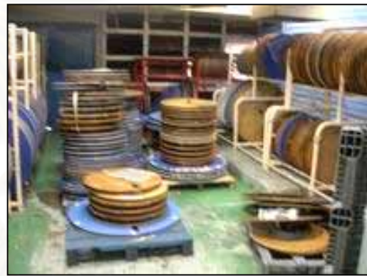
มีการวางรีลที่ไม่เป็นระเบียบ และไม่มีการจัดเก็บตามขนาด
