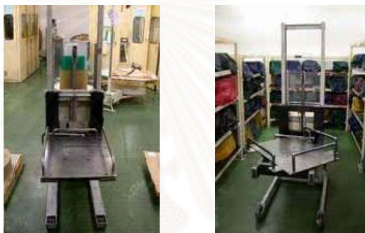
รูปที่ 5.10 รถเข็นแม่พิมพ์ก่อนและหลังปรับปรุง
