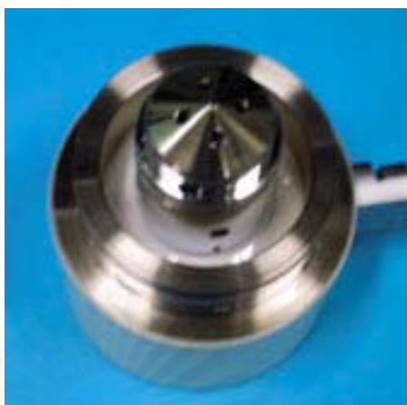
รูปที่ 3.2 wehnelt ที่ประกอบกับส่วนบนของปืนอิเล็กตรอน
