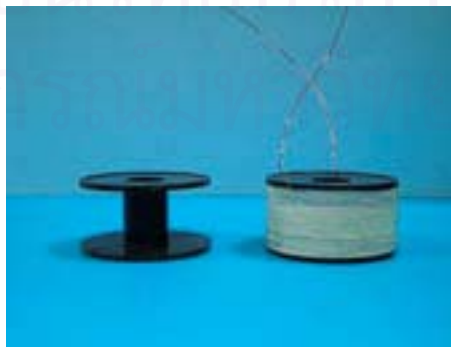
รูปที่ 3.11 แสดงบอบบินและขดลวดที่ถูกพันไว้สำหรับสร้างสนามแม่เหล็กไฟฟ้า
