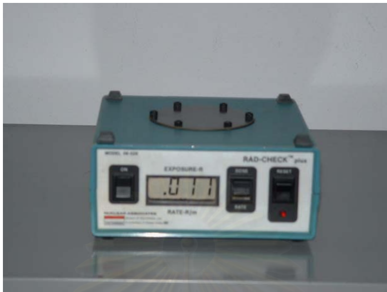
รูปที่ 3.7 เครื่องปริมาณวัดเอกซ์โพเซอร์ RMI
