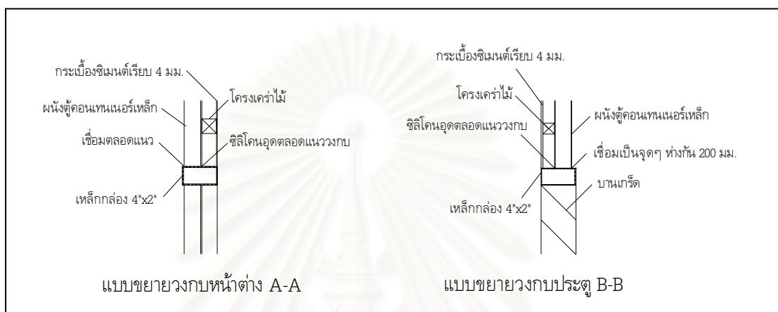
ภาพที่ 6.15 ภาพแสดงการติดตั้งวงกบประตู หน้าต่างแบบเดิม
