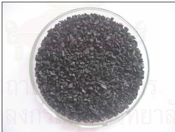
รูปที่ 4.5 กะลาปาล์มที่ผ่านการเผาและล้างสารกระตุ้นออกแล้ว
