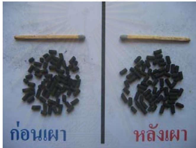
รูปที่ 4.12 ตัวดูดซับผลิตจากดินดำผสมกะลามะพร้าว 20:80 เเผาที่ 800 องศาเซลเซียส
