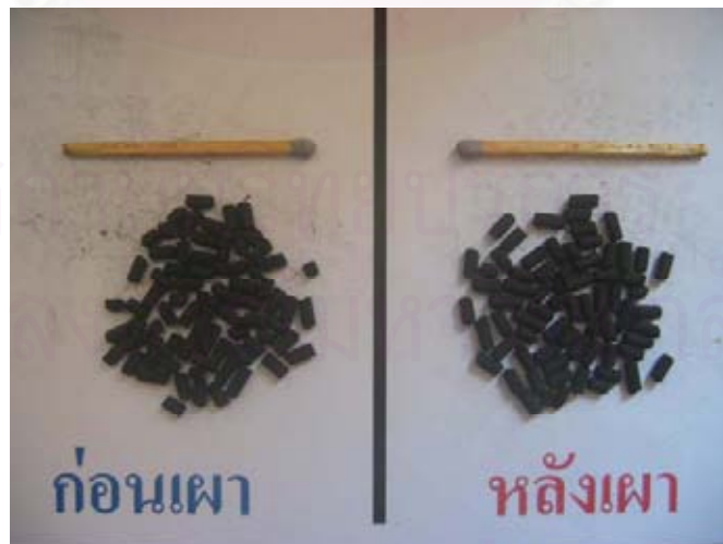
รูปที่ 4.13 ตัวดูดซับผลิตจากดินดำผสมกะลาปาล์ม 10:90 เเผาที่ 800 องศาเซลเซียส
