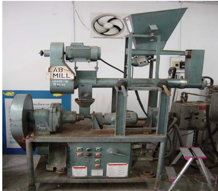
เครื่อง Pellet Mill สำหรับอัดเม็ดตัวดูดซับ
