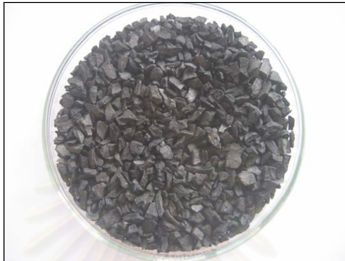
รูปที่ 4.4 กะลามะพร้าวที่ผ่านการเผาและล้างสารกระตุ้นออกแล้ว
