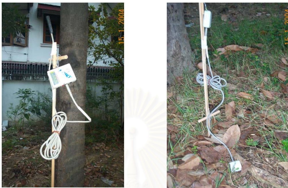
ภาพที่ 3-2 แสดงเครื่องเก็บข้อมูลอัตโนมัติ (Data Logger) อุณหภูมิพื้นผิว และอุณหภูมิอากาศ Hobo RH +Temperature Logger พร้อม Thermocouple Sensor
