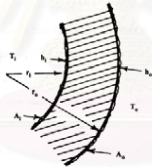
รูปที่ 3.6 แสดงภาพตัดของการถ่ายเทความร้อนระหว่างของไหลไปยังของไหล
