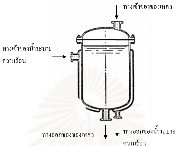
รูปที่ 2.9 เครื่องแลกเปลี่ยนความร้อนแบบปลอกหุ้ม
