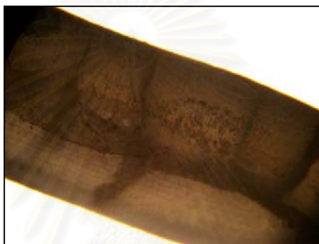
รูปที่ 4.8 ลักษณะการร้าวของเมล็ดข้าวที่ผ่านการอบแห้งด้วยเทคนิคฟลูอิดเซชันที่อุณหภูมิ 115°C (ภาพถ่ายจากกล้องจุลทรรศน์อิเล็กตรอน)
