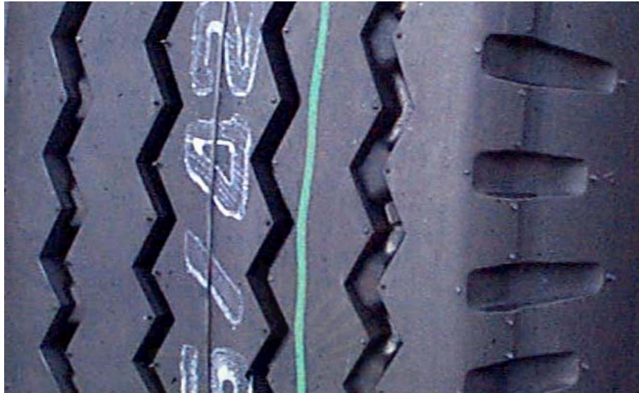
รูปที่ 3.3 ยางดอกลาย (Rib type)
