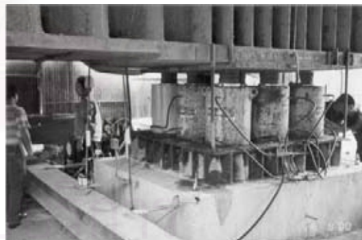
รูปที่ 2-37 การทดสอบแบบรับแรงกดโดยใช้เสาเข็มสมอเป็นตัวต้านน้ำหนัก
