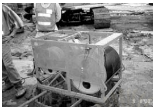
รูปที่ 4-26 การวัดขนาดของหลุมเจาะโดย เครื่องตรวจสอบสภาพหลุมเจาะ
