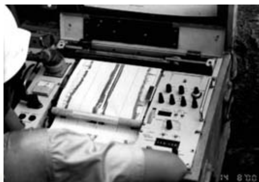
รูปที่ 4-27 ข้อมูลความหนาของผนังหลุมเจาะ
