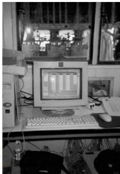
รูปที่ 3-2 คอมพิวเตอร์ใช้ประมวลผลการ ทดสอบเสาเข็ม
