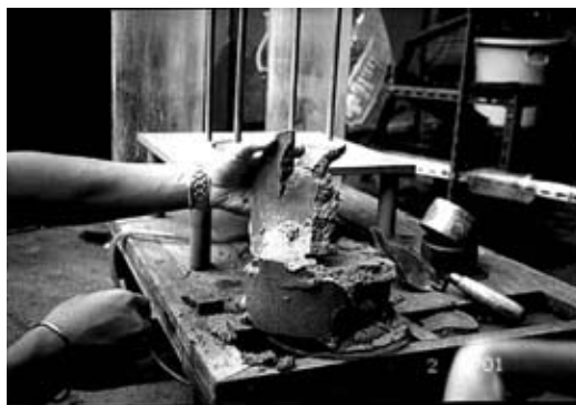
รูปที่ 3-9 ตัวอย่างทรายหลังการทดสอบการ ไหลผ่านของสารละลาย
