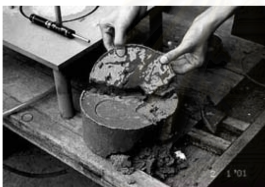
รูปที่ 4-13 ทรายที่ส่วนผิวหน้ามีกำลังเพิ่มขึ้นอย่างมากสามารถเกาะติดเป็นแผ่นได้
