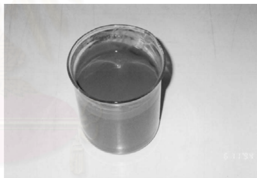
รูปที่ 2-19 เบนโทไนท์เมื่อผสมน้ำ (ส่วนผสม 5% โดยน้ำหนัก)
