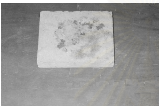
รูปที่ 3-10 แผ่นมอร์ทาร์ที่ใช้ทดสอบแรงเฉียดทาน
