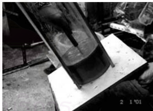
รูปที่ 3-7 การทดสอบกำลังของพีนิโตรมิเตอร์แบบพกพา
