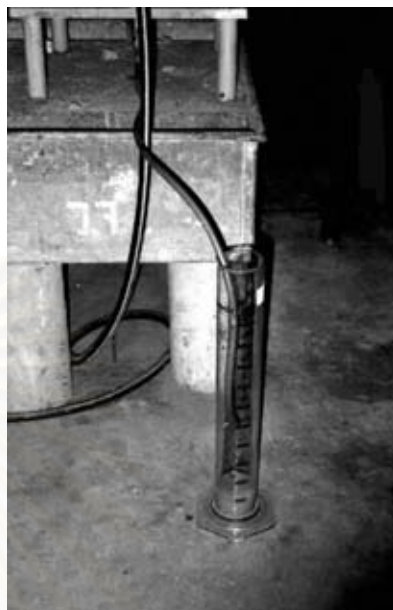
รูปที่ 3-5 ปริมาตรสารละลายที่ไหลผ่านชั้นทราย
