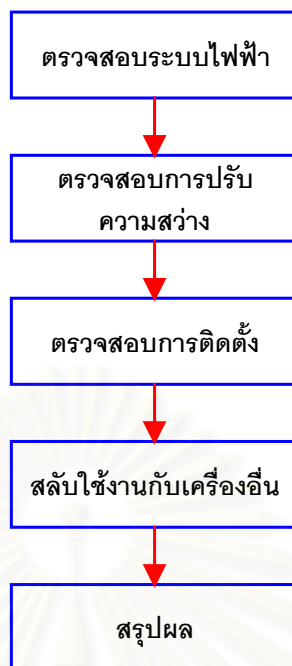
รูปที่ 4.12 แผนผังในการวินิจฉัยปัญหาจอภาพ
