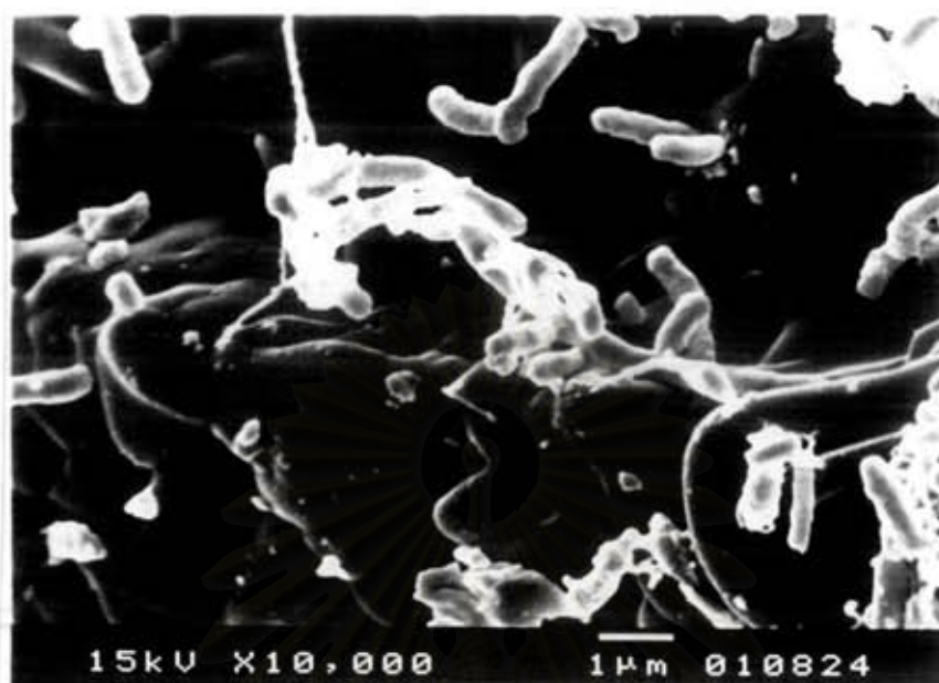
รูปที่ 41 ภาพถ่ายของเซลล์แบคทีเรียที่ยึดเกาะบนวัสดุตั้งซีโอไลท์ในชุดควบคุมในระบบรีเซอคูเลชัน จากกล้องจุลทรรศน์อิเล็กตรอนแบบส่องกราด ( กำลังขยาย 16420X )
