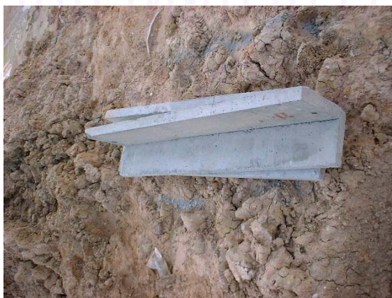
ภาพที่ 5.107 ชิ้นส่วนลูกบันได P1 ที่เสียหายจากการย้ายกองเก็บชิ้นส่วน
