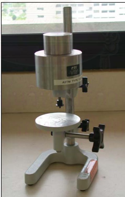
รูปที่ 31 แสดงเครื่องดิวโรมิเตอร์ที่นำมาใช้แทนน้ำหนัก 6 กก.
