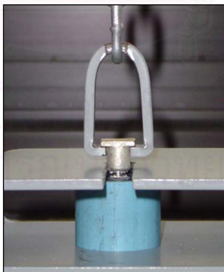
รูปที่ 34 แสดงการดึงกรอบออกจากหลักยึด
