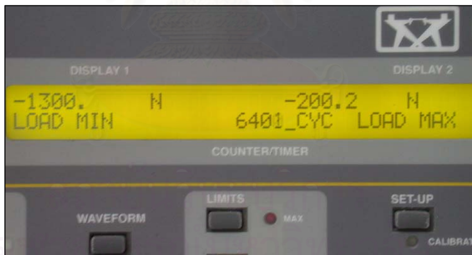
รูปที่ 41 แสดงหน้าจอบนแผงควบคุมขณะให้แรงอัดซ้ำ
