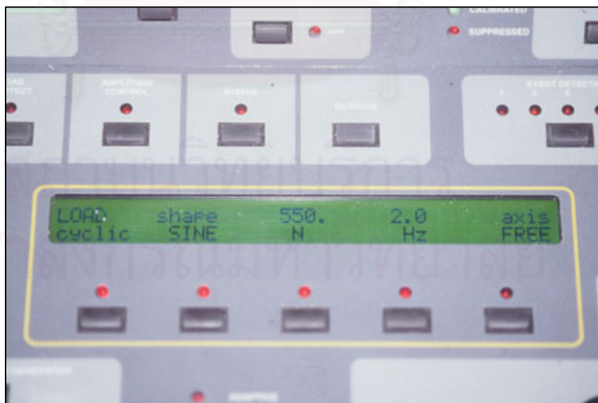
รูปที่ 39 แสดงหน้าจอบนแผงควบคุมแสดงการตั้งเครื่องทดสอบ
