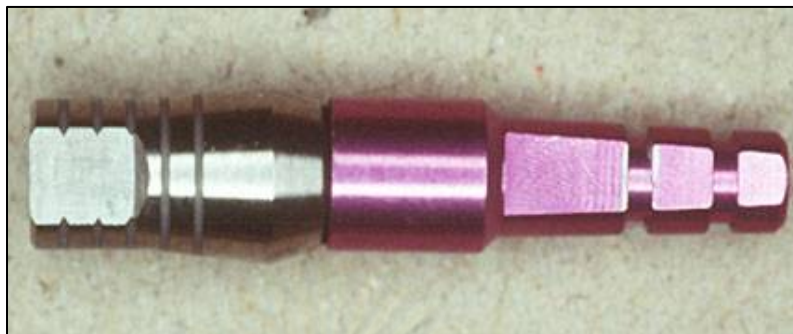
รูปที่ 6 แสดงหลักยึดรอกเทียมที่ยึดเข้ากับตัวเลียนแบบรอกเทียมด้วยสกรู
