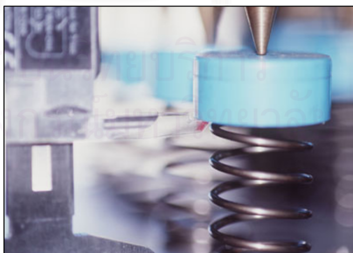
รูปที่ 48 แสดงการวัดความสูงของสปริง
