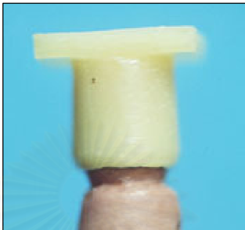
รูปที่ 17 แสดงขี้ผึ้งบนแม่แบบที่นำออกจากเบ้าหล่อ
