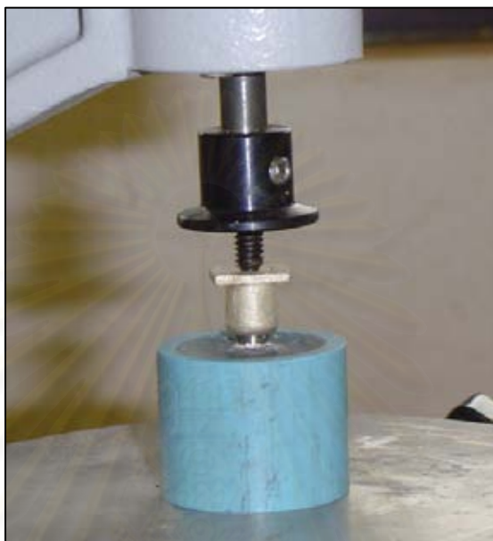
รูปที่ 32 แสดงการยึดครอบกับหลักยึดด้วยน้ำหนัก 6 กก.
