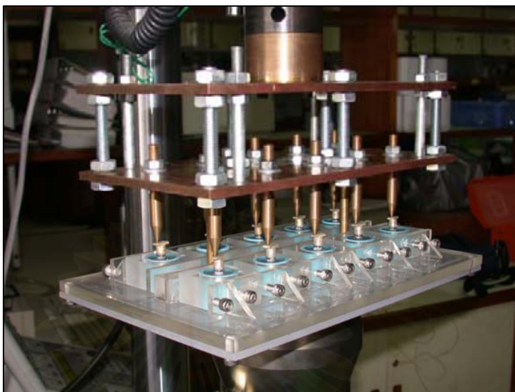
รูปที่ 36 แสดงหัวกดที่สามารถกดลงบนชิ้นทดสอบได้ครั้งละ 10 ชิ้น
