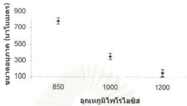
รูปที่ 4.16 ขนาดของอนุภาคบริเวณต้นท่อควอทซ์ต่อลูกเหล็กไฟโรไลซิส
