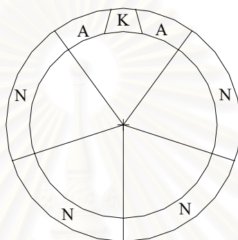
รูปที่ 2.13 หน้าตัดองค์ประกอบของชิ้นส่วนตาดอุโมงค์ใน 1 วง
