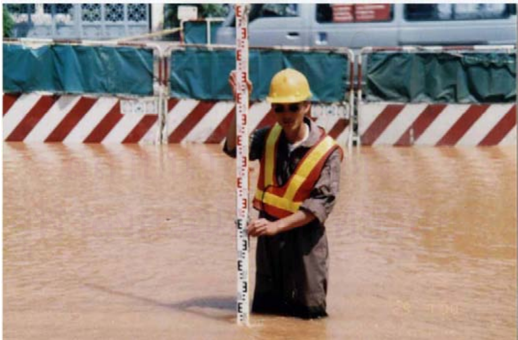
รูปที่ 5.13b ถนนเกิดการทรุดประมาณ 250 มิลลิเมตร ทำให้น้ำท่วมขึ้นมา อันเนื่องมาจากท่อส่งน้ำประปาแตกเสียหาย (MRTA, 2000)
