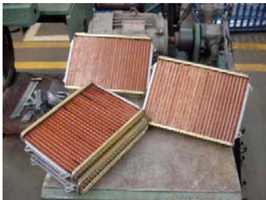
รูปที่ 3.9 รังผึ้งของหม้อน้ำตัวอย่าง (ก่อนผ่านการอบร้อน)
