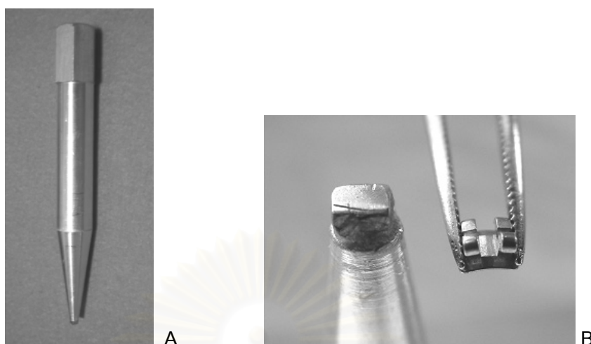
รูปที่ 28 แสดงหัวกัดลวดสำหรับต่อเข้ากับครอสเฮด ของเครื่องลอบด์ยูนิเวอร์แซลเทสติงมาซีน (A) มีหน้าตัดสี่เหลี่ยมผืนผ้า ขนาด 2.5 \times 3 มิลลิเมตร 2 ซึ่งเทียบได้กับขนาดความกว้างของแบร็กเกตฟันกรามน้อยล่าง 1 ซี่ (B)
