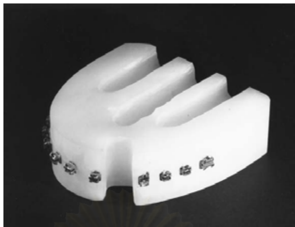
รูปที่ 13 แสดงรูปแบบการทดสอบความงอสามจุด โดยการใช้แบบจำลองที่มีแบร็กเกตแทนตำแหน่งพื้นทุกซี่ในการยึดเส้นลวด (31)
