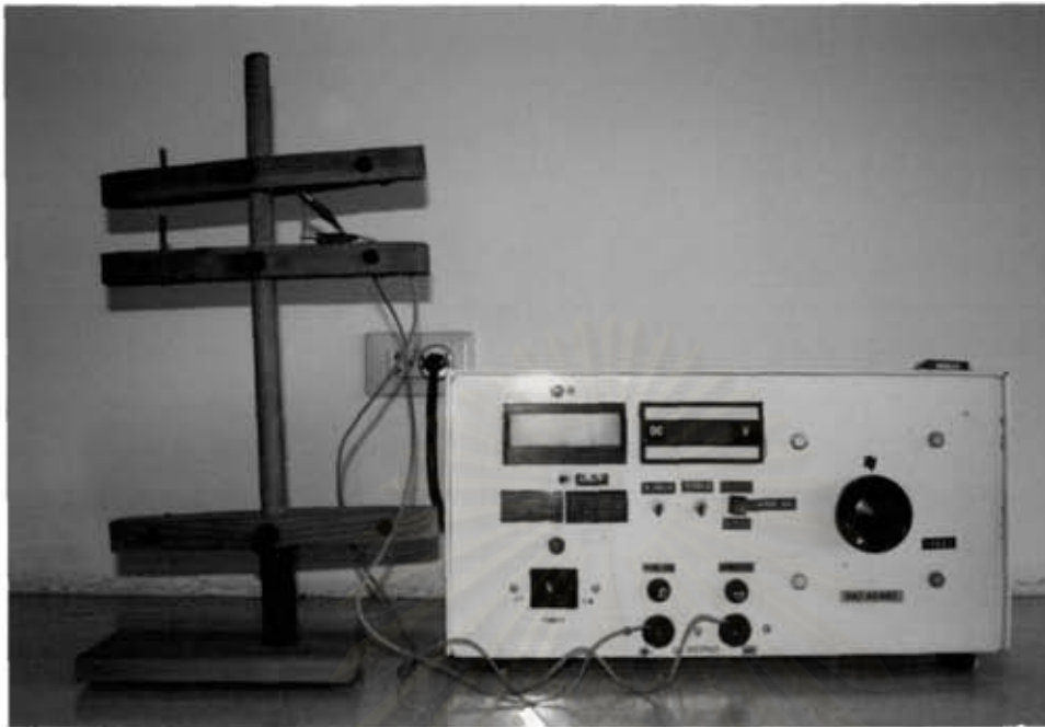
รูปที่ 3.1 อุปกรณ์วัดค่าความต้านทาน ( Resistivity)
