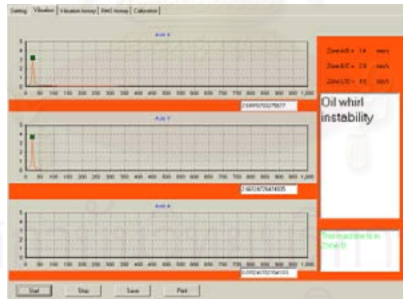
รูปที่ 5.12 สัญญาณและผลการวิเคราะห์ที่ได้กรณีการไหลวนของน้ำมันในร่องลื่นไม่คงที่
