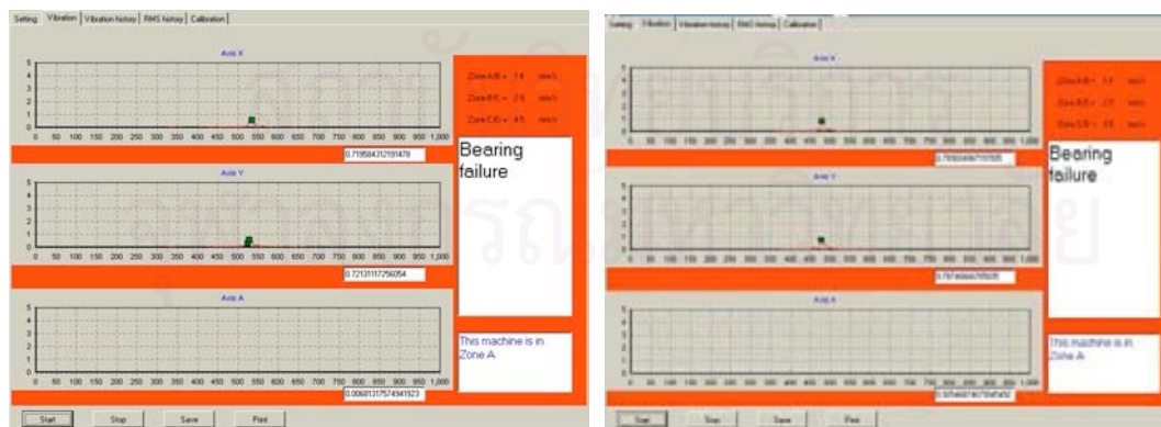
รูปที่ 5.10 สัญญาณและผลการวิเคราะห์ที่ได้ (ซ้าย BPF1, ขวา BPFO) กรณีตลับลูกปืนชนิดลูกกลิ้งเสียหาย
