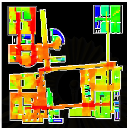
รูปที่ 2.21 การวิเคราะห์สนามทัศนด้วยโปรแกรม Visual Graph Analysis (VGA)
