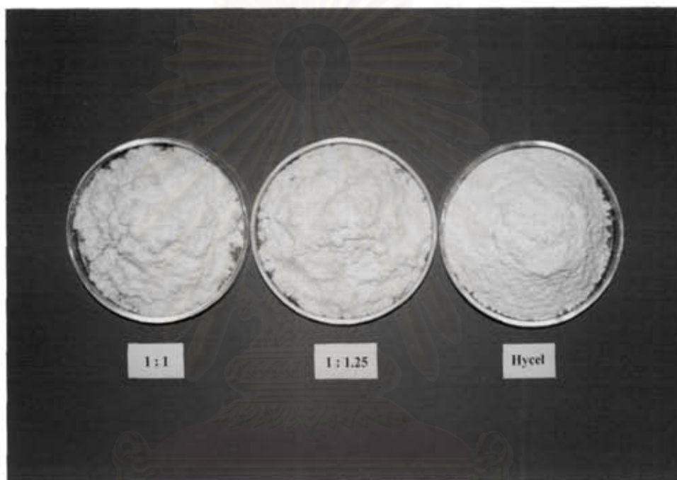
รูปที่ 4.10 แสดงลักษณะของซีเมนต์ที่ได้จากการทดลองโดยใช้อัตราส่วน เยื่อ : กรดโมโนคลอโรแอซิดิก เท่ากับ 1 : 1 และ 1 : 1.25 เปรียบเทียบกับซีเมนต์เกรดการค้า
