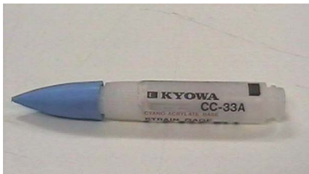
รูปที่ 4.6 สารยึดติดสเตรนเกจชนิด CC – 33A
