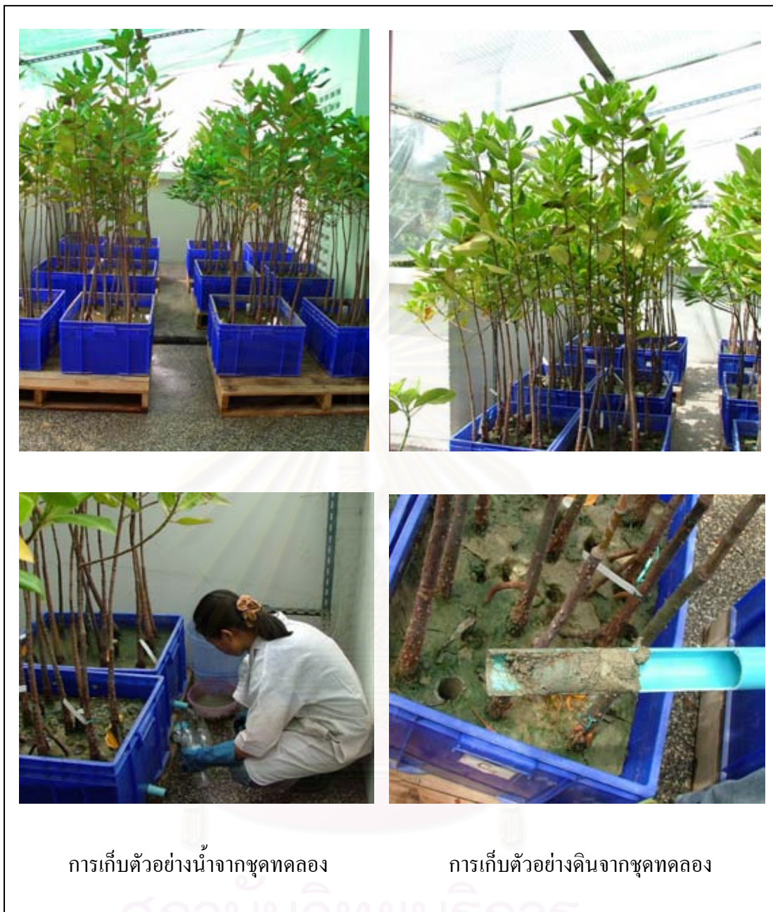
ภาพที่ ค.2 ชุดทดลองพื้นที่ชุ่มน้ำเทียม โกงกางใบใหญ่ ณ พื้นที่บริเวณระเบียง ชั้น 4 อาคารวิทยาศาสตร์ทั่วไป จุฬาลงกรณ์มหาวิทยาลัย เมื่อสิ้นสุดการทดลอง รวมทั้งการเก็บตัวอย่างน้ำและดิน
