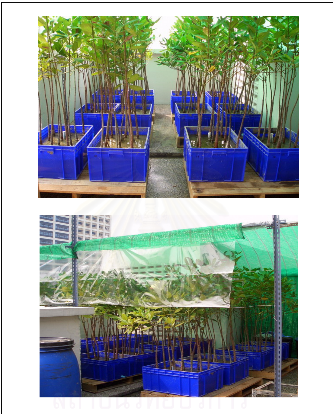
ภาพที่ ค.1 ชุดทดลองพื้นที่ชุ่มน้ำเทียมโกงกางใบใหญ่ ณ พื้นที่บริเวณระเบียบ ชั้น 4 อาคารวิทยาศาสตร์ทั่วไป จุฬาลงกรณ์มหาวิทยาลัย ก่อนเริ่มการทดลอง
