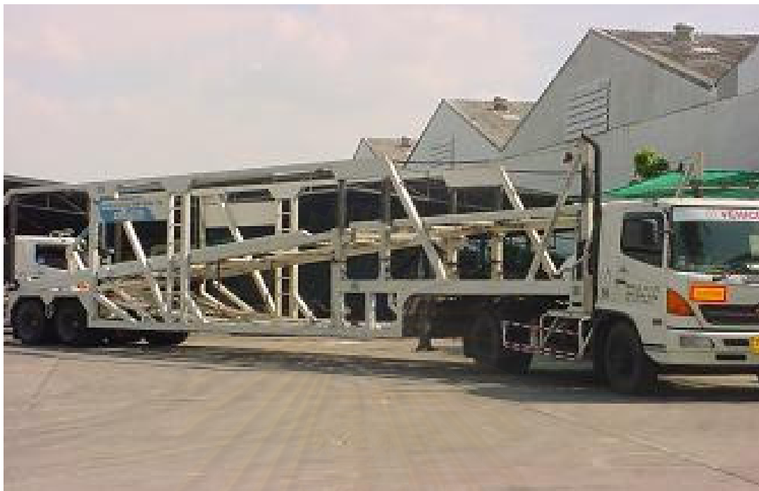
รูปที่ 3.3 รถเทรลเลอร์ บรรทุกสินค้ารถยนต์ 6 คัน
