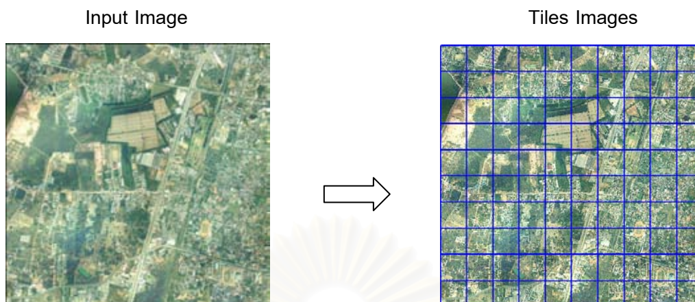
รูปที่ 2.2 การแบ่งส่วนข้อมูลภาพ
