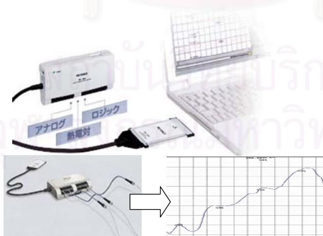
รูปที่ 3.2 แสดงอุปกรณ์เชื่อมต่อ KEYENCE รุ่น NR-250 PC
