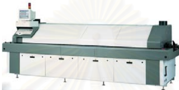
รูปที่ 1.2 เครื่องรีโฟลว์ในอุตสาหกรรมไฟฟ้าและอิเล็กทรอนิกส์
