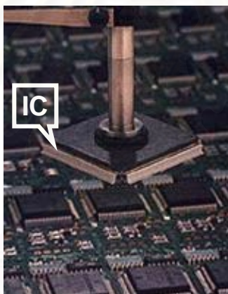
รูปที่ 2.13 แสดงแผงวงจรกำลังวางชิปวงจรรวม
