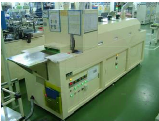
รูปที่ 2.6 แสดงเครื่องรีโฟลว์ในกระบวนการผลิตตัวเก็บประจุชนิดแทนทาลัม
