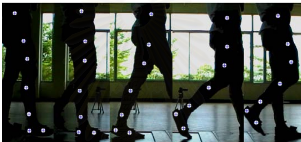
รูปที่ 3.23 ภาพในเฟรมต่าง ๆ พร้อมจุดศูนย์กลางของมาร์กเกอร์จากการประมวลผลภาพ
