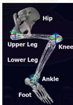
รูปที่ 3.26 ข้อต่อที่สร้างขึ้นและเส้นบอกแนวแกนของโมเดล
