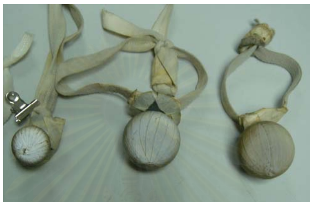
รูปที่ 3.6 ลักษณะของ Marker ที่นำมาใช้ประกอบด้วยปุ่มและสายรัดด้านหลัง
