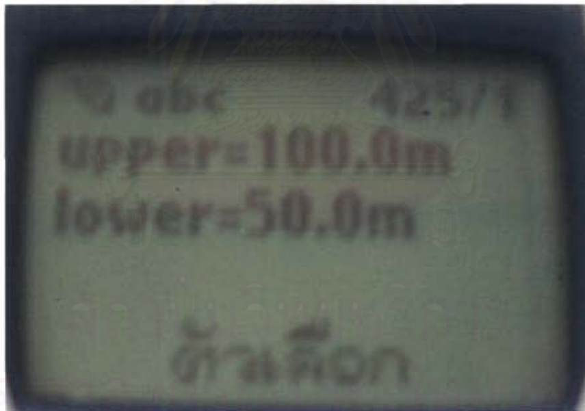
รูปที่ 8.13 การกำหนดค่าจากผู้ใช้ ค่าสูงสุด = 100 เมตร และ ต่ำสุด = 50 เมตร
