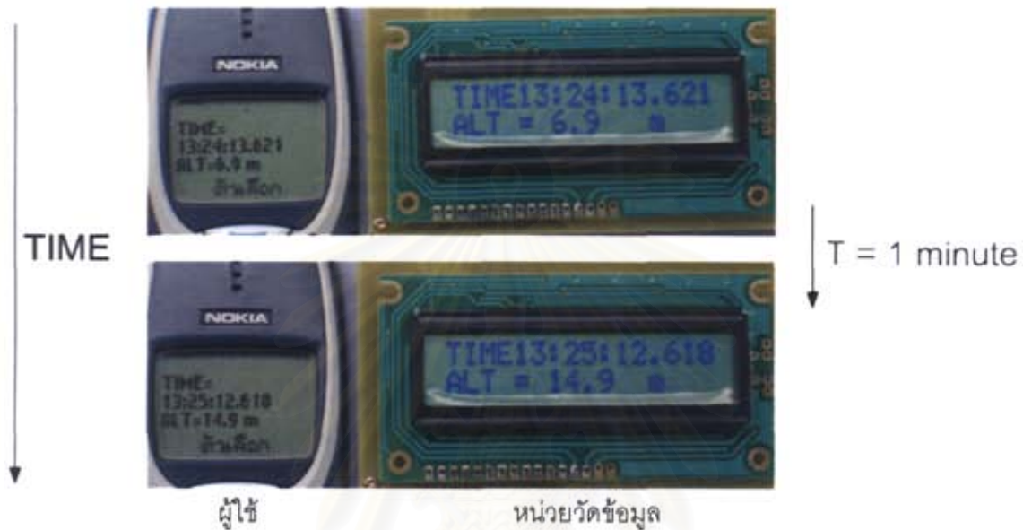
รูปที่ 8.9 ผลการทดสอบการทำงานโมดที่ 2 ที่บริเวณบันไดชั้นที่ 1 ของอาคาร เดินขึ้นไปยังชั้นที่ 3
