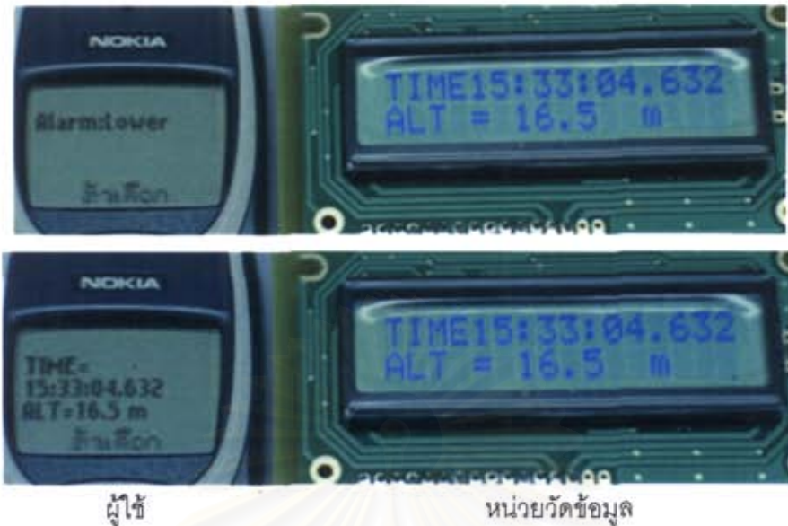
รูปที่ 8.14 ผลการทดสอบเมื่อมีการแจ้งเตือนว่าค่าที่วัดได้มีค่าต่ำกว่าค่าที่กำหนด
