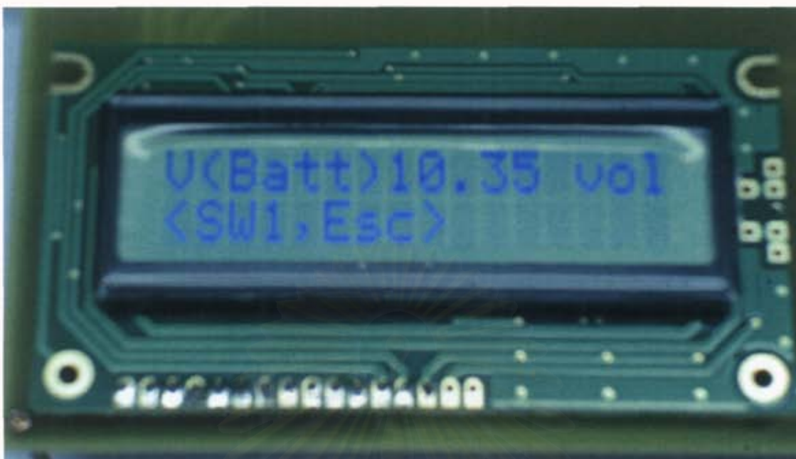
รูปที่ 8.2 การตรวจสอบระดับแรงดันที่ป้อนให้แผงทดสอบของระบบ
