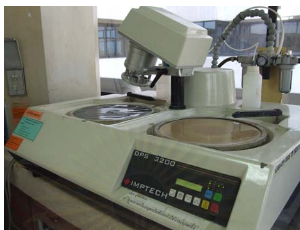
รูปที่ 4 เครื่องขัดผิววัสดุ (DPS 3200, IMPTECH, แอฟริกาใต้)
