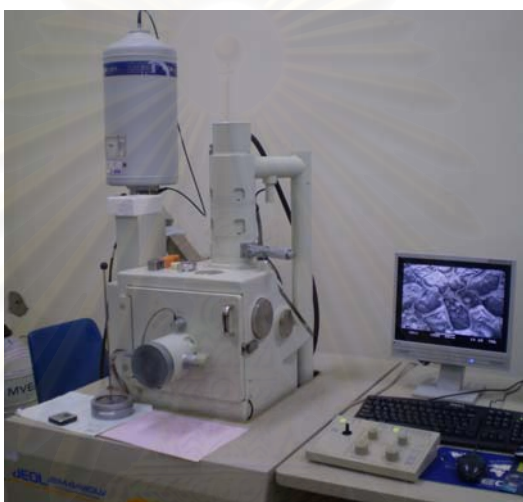
รูปที่ 10 กล้องจุลทรรศน์อิเล็กตรอนแบบส่องกราด ขยาย 30,000 เท่าที่ 20 KV (JSM-6480LV, JEOL, Eching b. München, เยอรมัน)
