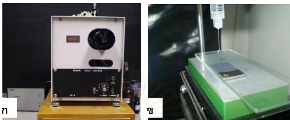
รูปที่ 8 ภาพแสดงการหาค่ามุมสัมพัทธ์ ก. คอนแทกแองเกิลมิเตอร์ ข. วัดค่ามุมสัมพัทธ์โดยการใช้ น้ำกลั่น
