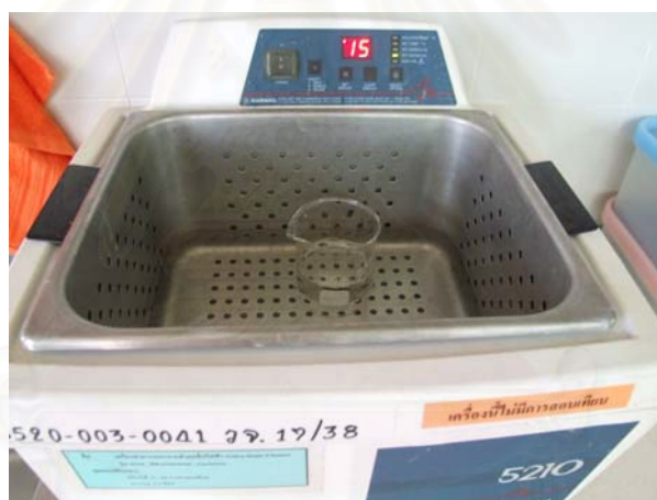
รูปที่ 5 การทำความสะอาดด้วยเครื่องอัลตราโซนิกในสารละลายอะซีโตน 5 นาที
