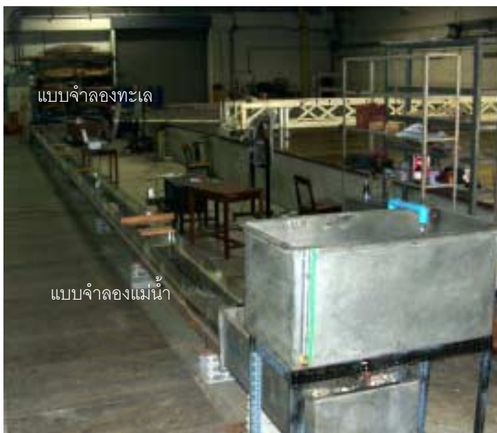
รูป 3-3 แบบจำลองชลศาสตร์การไหลในทางน้ำเปิดที่มีเขื่อนกั้นภายใต้อิทธิพลของน้ำขึ้นน้ำลง
