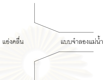
รูป 6-2 การสร้างบริเวณปากแม่น้ำของแบบจำลองให้ฝายออกสู่แอ่งคลื่น เพื่อแก้ปัญหการเปลี่ยนแปลงหน้าตัดทางน้ำฉับพลัน
