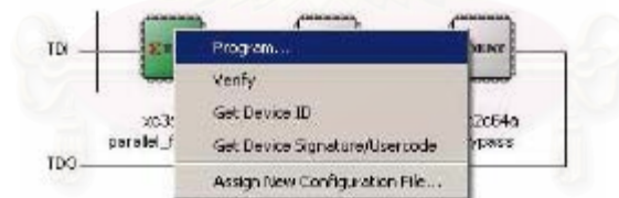
รูปที่ 6.9 การโปรแกรม Nor Flash Programmer ลงเฟสพีซีไอ
