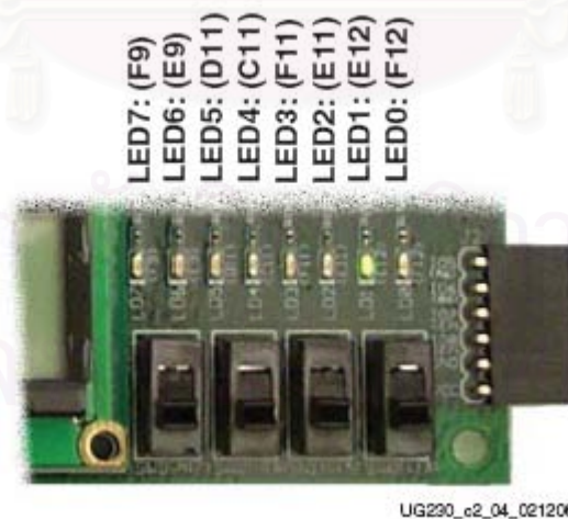
รูปที่ 6.18 หลอดแอลอีดีและตำแหน่งการวางขา
