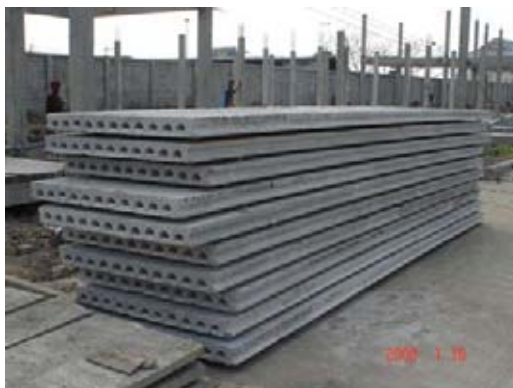
ภาพที่ 5.30 แสดงพื้นคอนกรีตอัดแรงแบบกลวง
