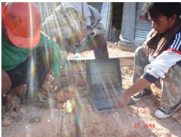
ภาพที่ 5.6 แสดงการตรวจสอบคุณภาพของเข็มเมื่อเกิดปัญหา
