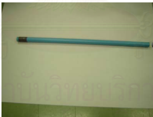
รูปที่ 3.9 ภาพถ่ายท่อบรรจุต้นกำเนิดนิวตรอน ^{241}\text{Am/Be} ความแรงรังสี 500 มิลลิวูร์
