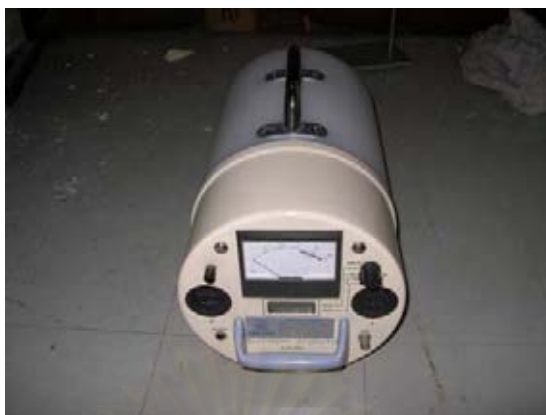
รูปที่ 3.3 เครื่องสำรวจปริมาณรังสีนิวตรอน
