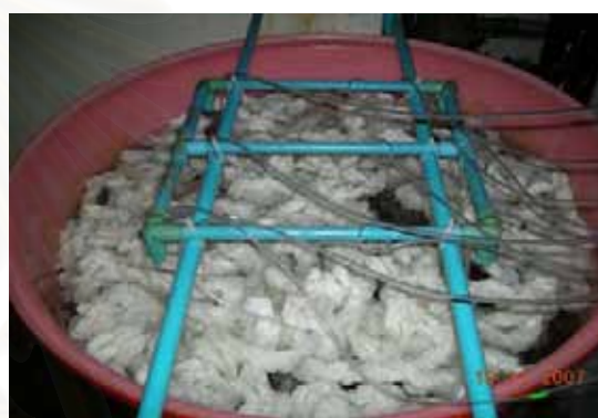
ภาพที่ 3-2 ถังบ่มตัวกรองชีวภาพไนตริไฟเคชัน
