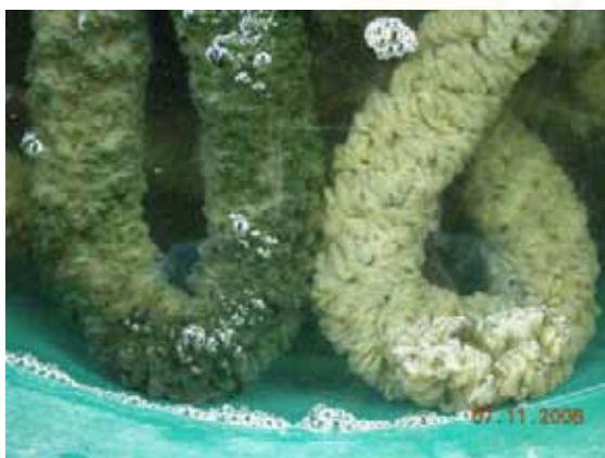
เปรียบเทียบตัวกรองก่อน (ซ้าย) และหลัง (ขวา)
