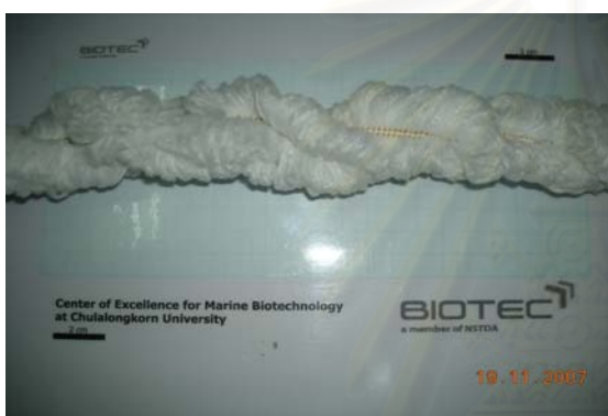
ภาพที่ 3-1 ตัวกรองชีวภาพไนตริไฟเคชัน
