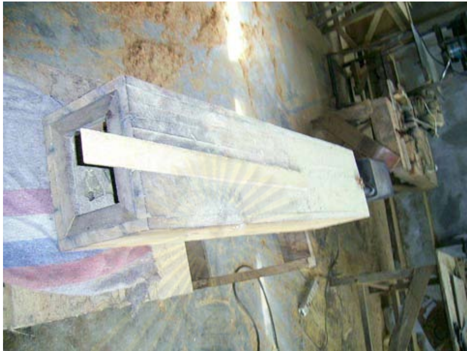
ภาพภูมิปัญญาการเตรียม ไม้แฉลบไอน้ำ
