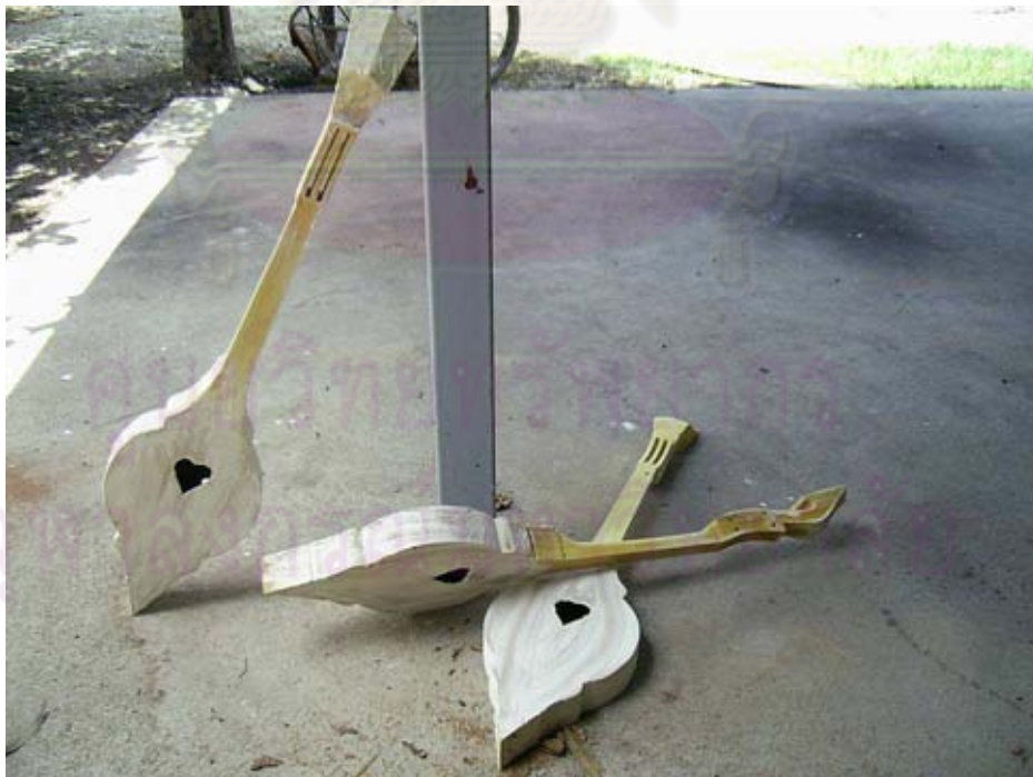
ภาพการเคลือบด้วยดินสอพองสีให้แห้ง
