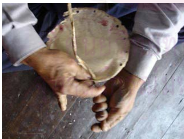
ภาพการร้อยเชือกหนังรอบแผ่นหนังสำหรับึงหน้ากลอง
