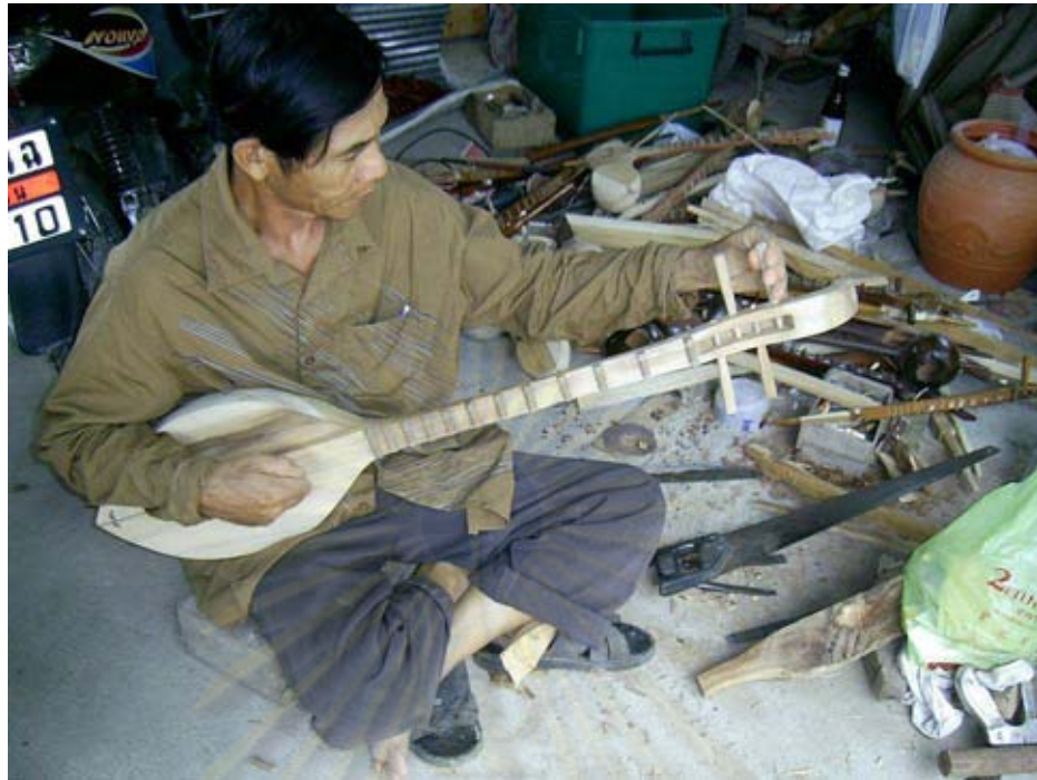
ภาพใส่ลูกติดนม-ก๊อป ลูกบิด ใส่สาย ๔ สาย
