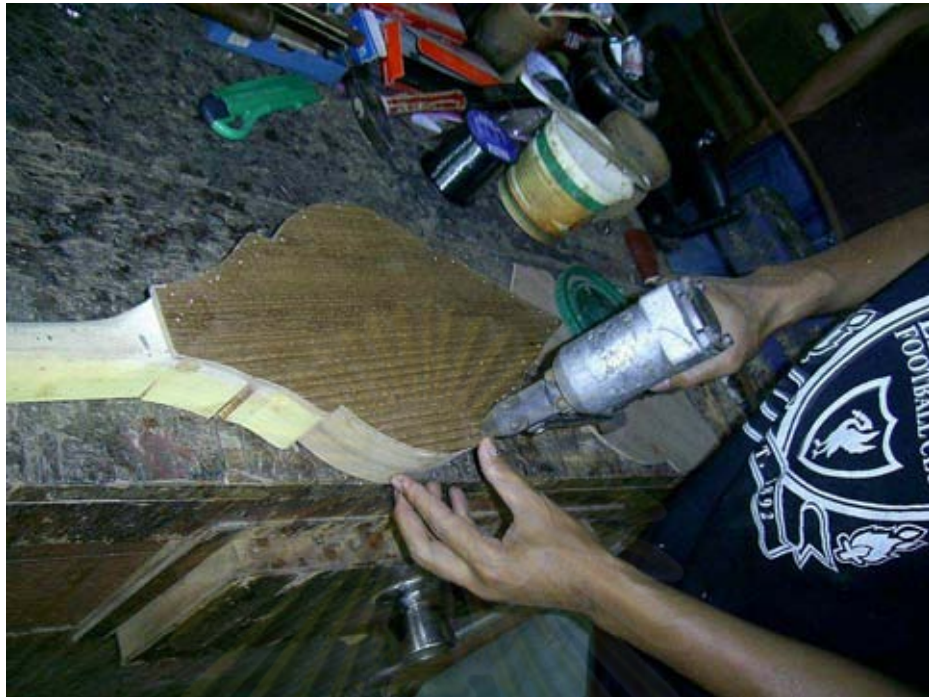
ภาพการประกอบซึ่งโดยใช้ไม้อัดสักระกบด้านล่างหรือด้านหลังกะโหลกซึ่ง
