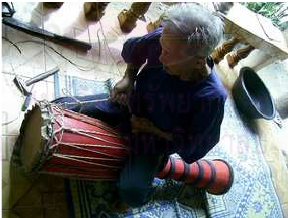
ภาพต่อเนื่อง การหุ้มหนังลูกว้าวด้วยการร้อยหนังหูหึง
