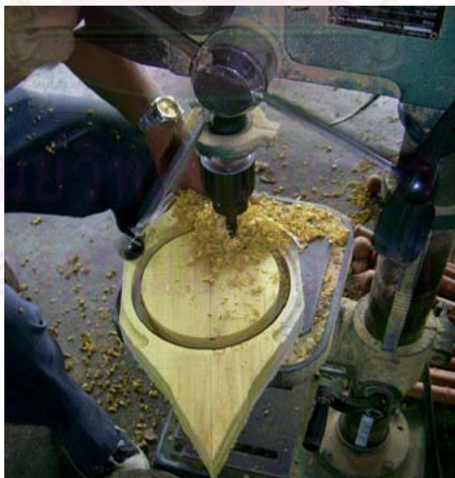
ภาพการใช้สว่านเจาะไฟฟ้าจุดซึ่งกลาง
