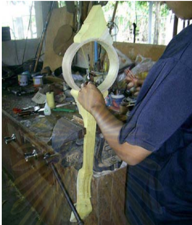
ภาพการทำกะโหลกซึ่งมาประกบกันทวนและหัวซึ่งตอกยึดด้วยตะปู
