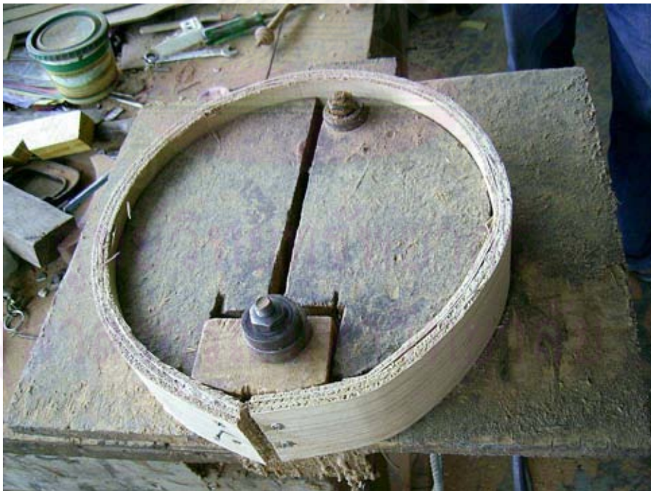
ภาพการขัดไม้อัดด้วยไม้แบบให้เป็นรูปวงกลม
