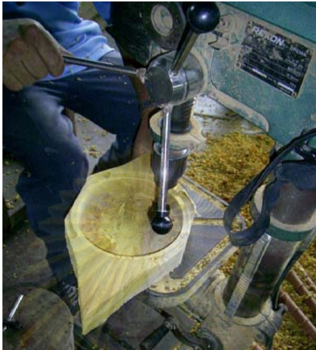
ภาพการแต่งด้วยกระดาษทราย โดยใช้สว่านไฟฟ้า
