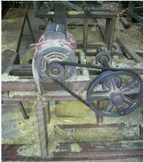
ภาพแท่นกลึงซึ่งประกอบไปด้วยสายพานและมอเตอร์ไฟฟ้า
