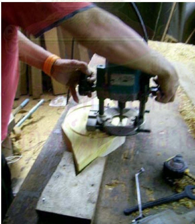
ภาพขุดกะโหลกซึ่งโดยใช้เครื่องล้อยึดเตอร์เจาะเป็นวงกลมด้านขวามือ
