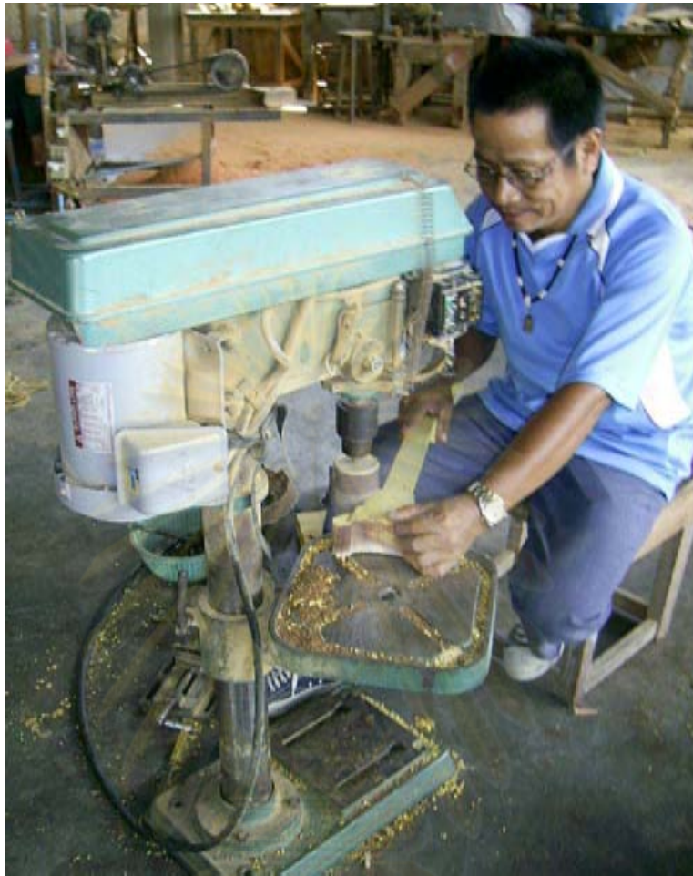
ภาพการนำหุ่นหมุนติดกระดาษทรายต่อด้วยเครื่องเจาะไฟฟ้าเป็นตัวหมุน ขณะขัดส่วนเว้า ของคันทวนและหัวซึ่ง
