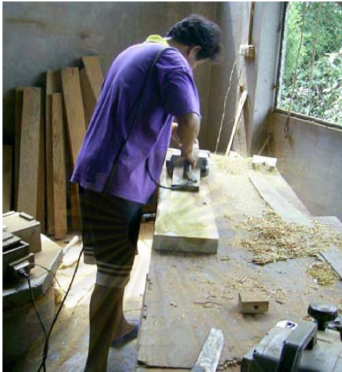
ภาพนำไม้มาไสให้ผิวเรียบด้วยกบไฟฟ้า
