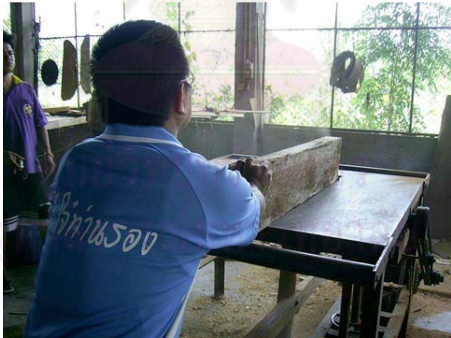
ภาพการทำซึ่งขุดโดยใช้เลื่อยไฟฟ้าขึ้นรูป
