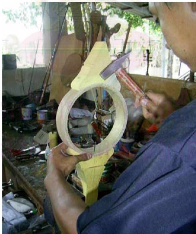
ภาพการทำกะโหลกซึ่งมาประกบกันทวนและหัวซึ่งแล้วตอกยึดด้วยตะปูช่วงท้ายซึ่ง
