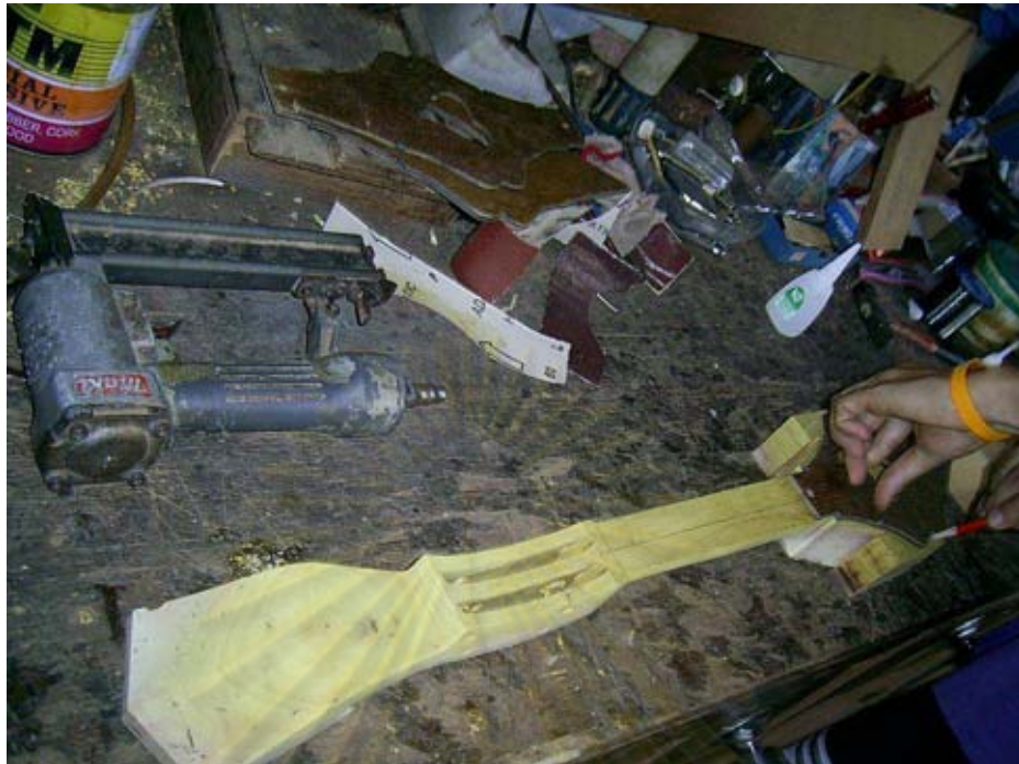
ภาพคันทวนและหัวซึ่งทากาวเพื่อประกบไม้ด้านข้าง
