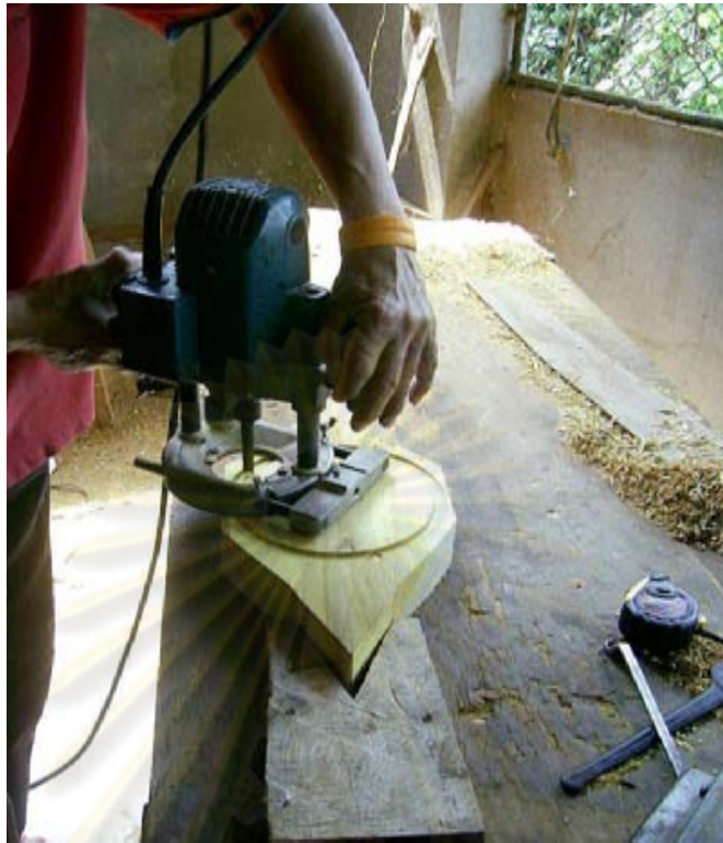
ภาพขุดกะโหลกซึ่งโดยใช้ล้อยึดเตอร์เจาะเป็นวงกลมด้านซ้ายมือ
