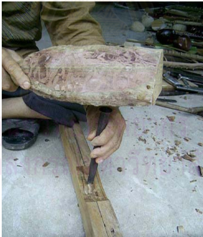
ภาพการใช้สิ่วและก้อนไม้เจาะส่วนหัวซึ่งกลาง
