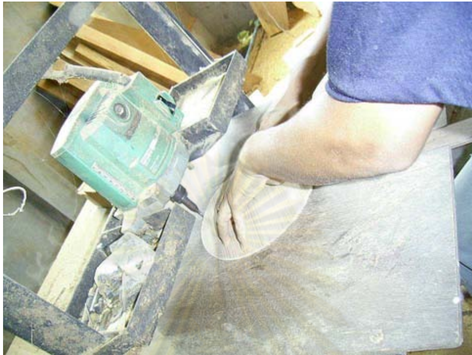
ภาพการขัดไม้อัดขึ้นรูปกะโหลกซิง
