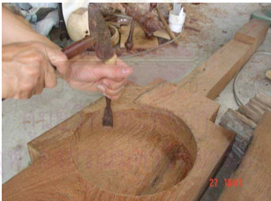
ภาพการเจาะกะโหลกซึ่งกลางด้วยส่วและค้อน
