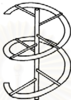
รูปที่ 2-6 ลักษณะใบกวนแบบ Helical ribbon (Harnby, 1985)
