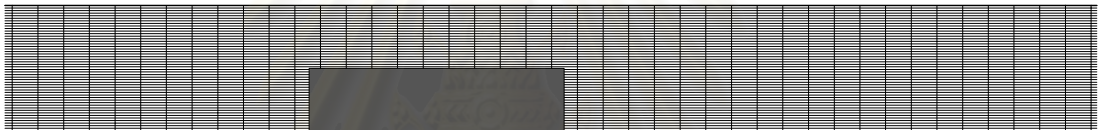
รูปที่ 4.3 รูปร่างของกริดขนาด 100 \times 50 ที่ใช้ในการคำนวณ (Not to scale)
