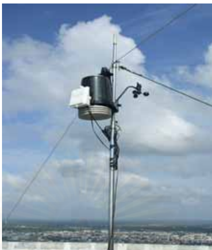
ภาพที่ 3.7 แสดงเครื่องมือตรวจวัดอนุภาคมินิวิฟ
