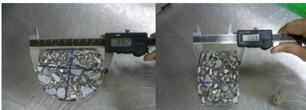
ภาพที่ 3.5 การวัดขนาดของก้อนตัวอย่าง
