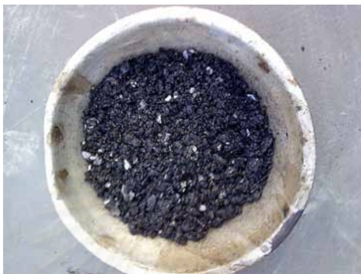
ภาพที่ 3.14 ก้อนตัวอย่างแอสฟัลต์คอนกรีตแยกตัวกัน
