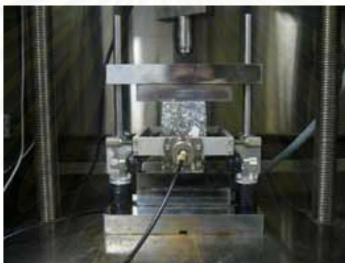
ภาพที่ 3.9 การจัดวางก้อนตัวอย่างในการทดสอบหาค่าโมดูลัสคืบตัว
