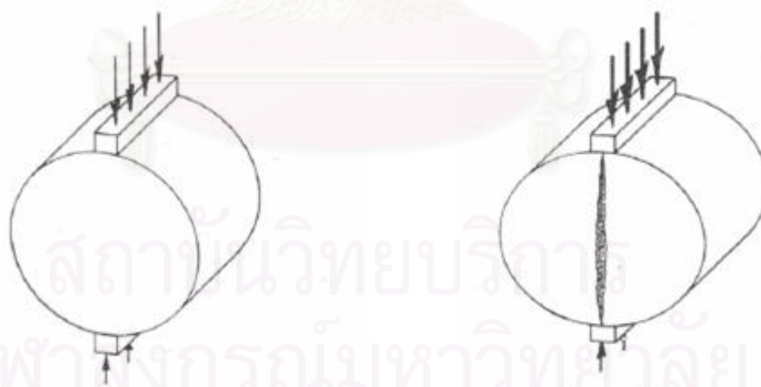
ภาพที่ 2.2 การให้น้ำหนักกระทำก้อนตัวอย่างและลักษณะการแตกร้าวของก้อนตัวอย่าง ที่มา: ชัยรัตน์ พรหมสร และคณะ (2546)
