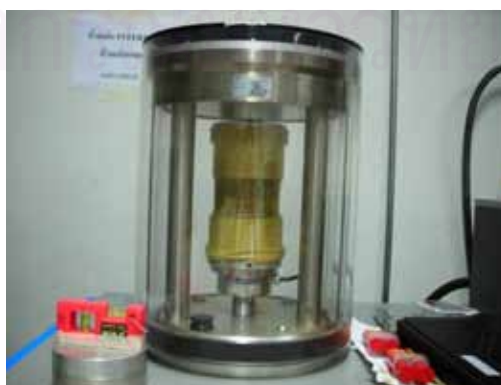
ภาพที่ 3.11 การจัดวางก้อนตัวอย่างในการทดสอบหาค่าการยุบตัวถาวร
