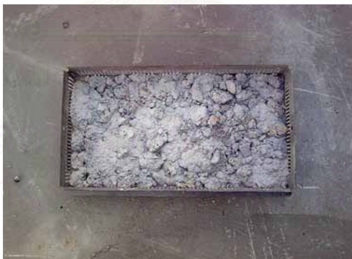
ภาพที่ 3.15 มวลรวมที่เหลือจากการเผา
