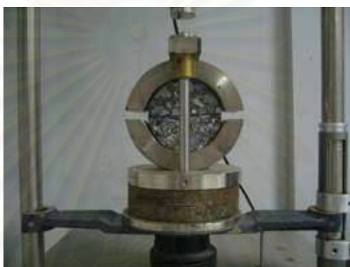
ภาพที่ 3.7 การจัดวางก้อนตัวอย่างในการทดสอบแบบแบบมาร์แชลล์
