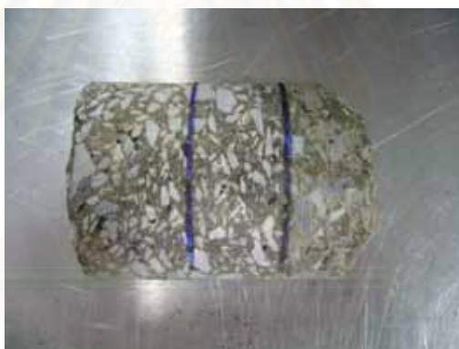
ภาพที่ 3.2 การขีดเส้นทำเครื่องหมายแบ่งชั้นของก้อนตัวอย่าง
