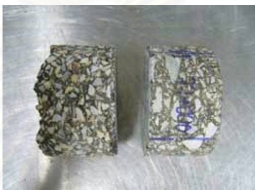
ภาพที่ 3.4 ก้อนตัวอย่างเมื่อทำการตัดเรียบร้อย
