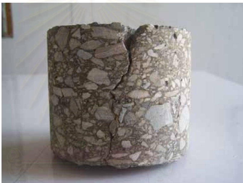
ภาพที่ 2.1 ก้อนตัวอย่างที่เสียหายจากรอยแตกจากบนลงล่าง (Top-Down Crack)
