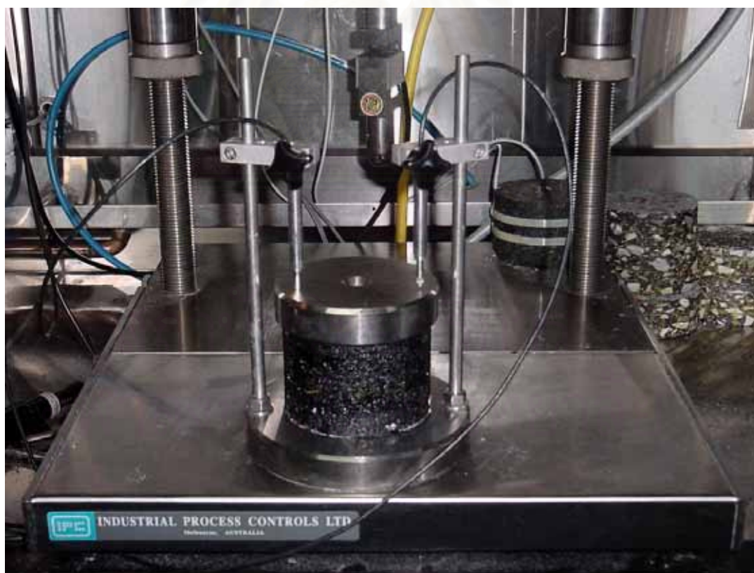
รูปที่ 3.10 ลักษณะการจัดวางก้อนตัวอย่างสำหรับการทดสอบ Dynamic creep test
