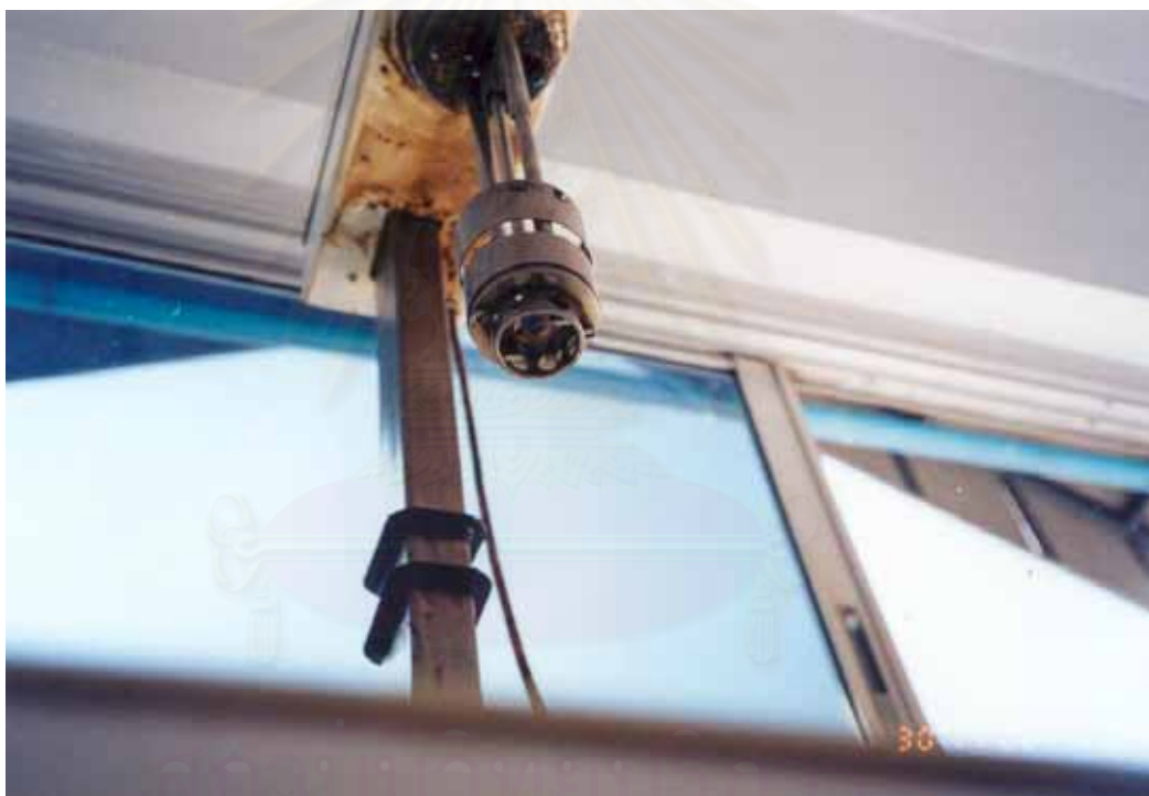
รูปที่ 3.2 ลักษณะใบพัดของเครื่องผสมแรงเฉือนสูง
