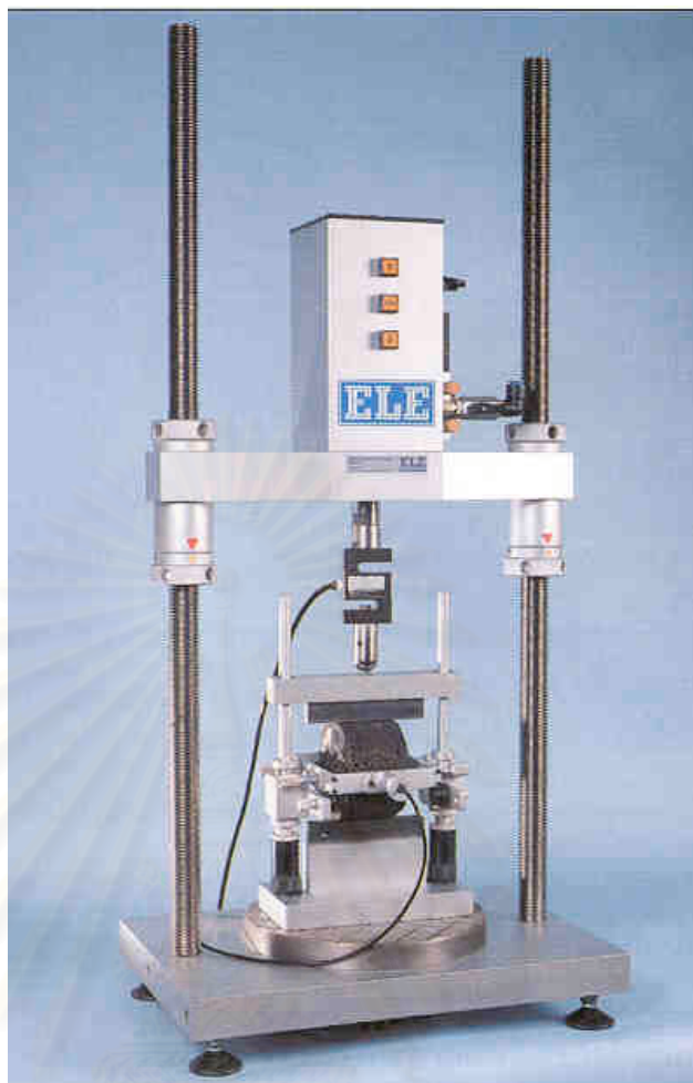
รูปที่ 3.9 ลักษณะการจัดวางก้อนตัวอย่างเพื่อทดสอบแรงดึงทางอ้อม
