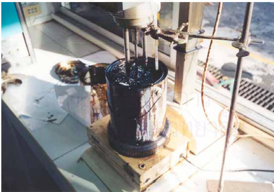
รูปที่ 3.7 ลักษณะของเนื้อยางที่ลอยบนผิวหน้าของส่วนผสม
