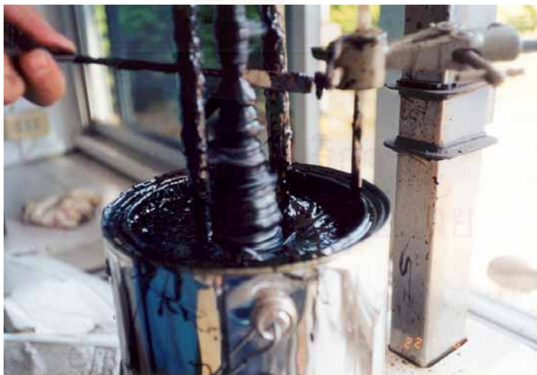
รูปที่ 3.4 ลักษณะของส่วนผสมเมื่อน้ำยางข้นเกิดการเดือดและไต่ขึ้นแกนเครื่องผสม
