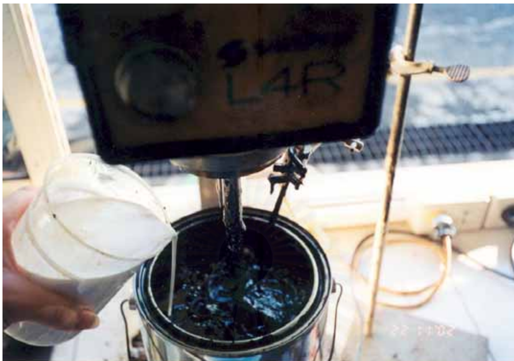
รูปที่ 3.3 การผสมน้ำยางข้นกับวัสดุแอสฟัลต์ซีเมนต์
