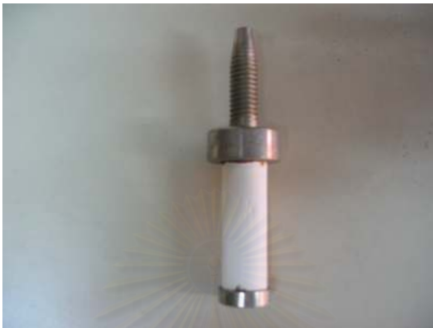
รูปที่ 4.25 โขเดียมอะลูมินาซีโอไลต์เมมเบรนบนชั้นรองรับ corundum
