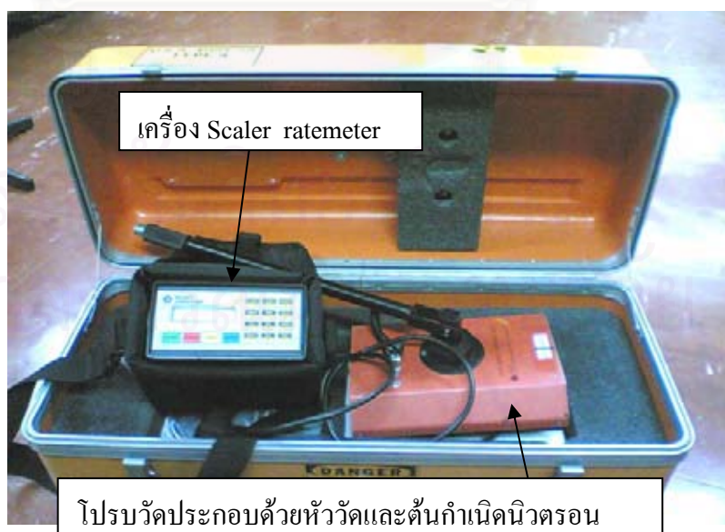
รูปที่ 3.3 ภาพเครื่อง HYDROTECTOR ของบริษัท Boart longyear
