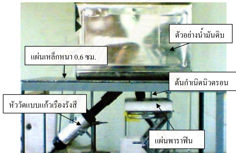
รูปที่ 3.1 แผนภาพและภาพการจัดวางต้นกำเนิดนิวตรอนและหัววัดนิวตรอนในการนับเทอร์มัลนิวตรอนจากการกระเจิงกลับ (ลักษณะที่ 1 ไม่ใช้วัสดุบังคับลำนิวตรอน)
