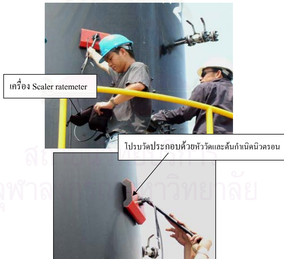
รูปที่ 3.11 ภาพระบบการตรวจหารอยต่อระหว่างน้ำมันดิบกับน้ำในภาคสนามโดยใช้เทคนิคการส่งผ่านรังสีแกมมา
