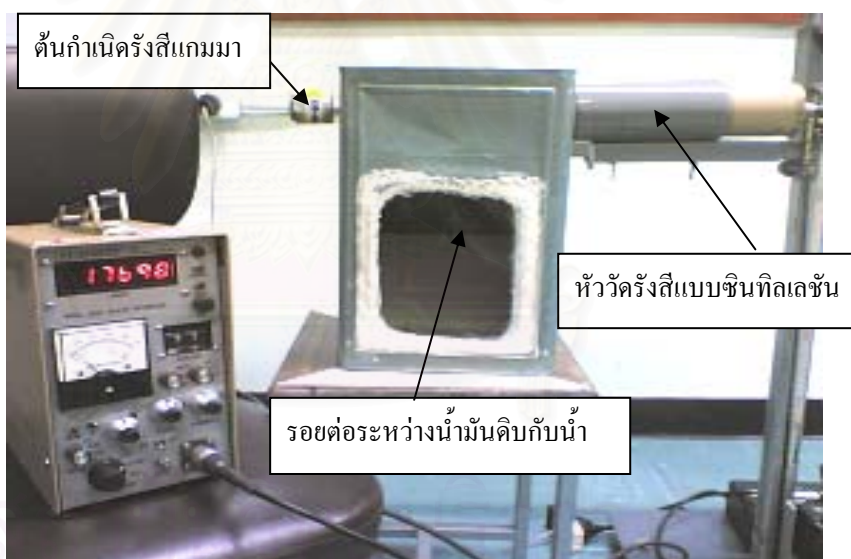
รูปที่ 3.9 ภาพระบบการตรวจหารอยต่อระหว่างน้ำมันดิบกับน้ำในห้องปฏิบัติการโดยใช้เทคนิคการส่งผ่านรังสีแกมมา
