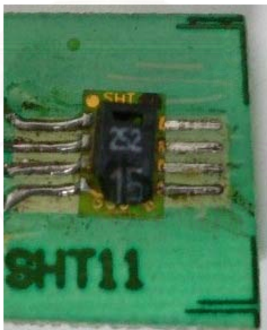
รูปที่ 6.6 แผงวงจรพิมพ์ของเซนเซอร์ดิจิทัล SHT11 (ที่ประกอบเสร็จแล้ว)
