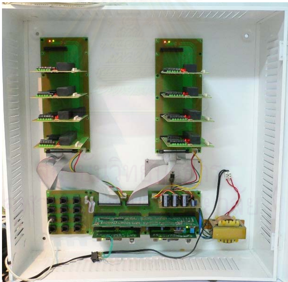
รูปที่ 6.11 ตัวควบคุมที่ประกอบเสร็จแล้ว
