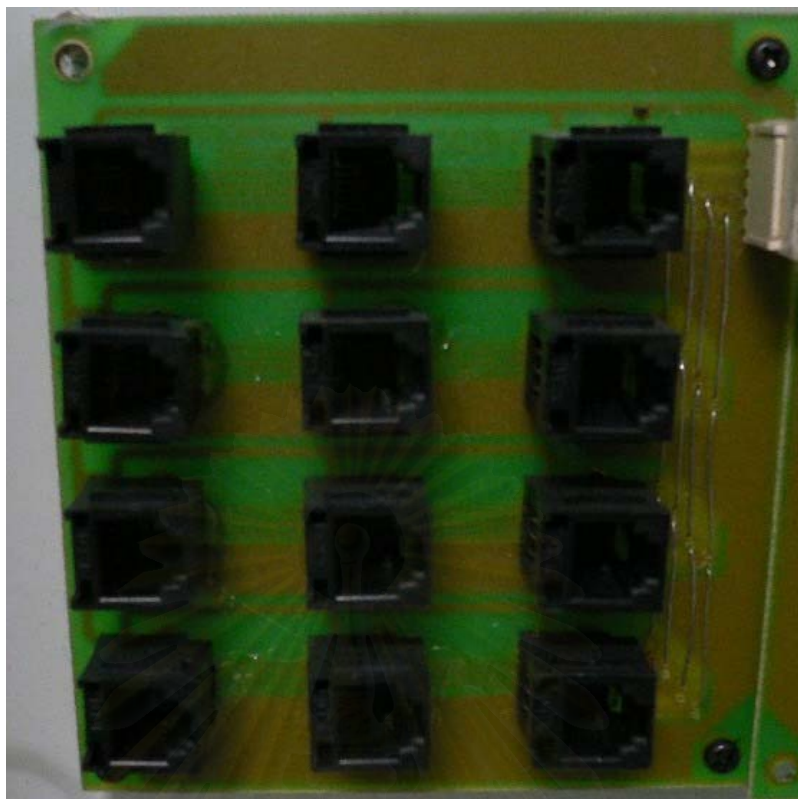
รูปที่ 6.5 แผงวงจรพิมพ์ของแผงเชื่อมต่อ (ที่ประกอบเสร็จแล้ว)
