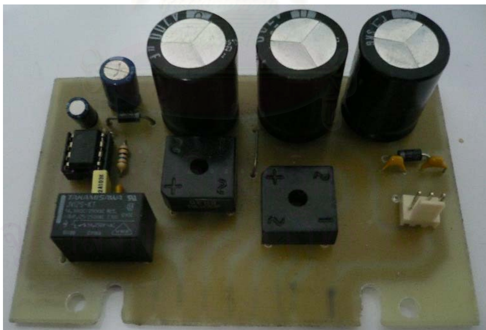
รูปที่ 6.4 แผงวงจรพิมพ์ของแผงจ่ายไฟ (ที่ประกอบเสร็จแล้ว)
