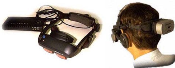
รูปที่ 2. 28 แสดงอุปกรณ์จอภาพสวมศีรษะ (HMD) และอุปกรณ์จับตำแหน่งและทิศทาง (Tracking Device) (ที่มา: http://www.usc.edu/dept/architecture/mbs/thesis/anish/thesis_report.htm )
