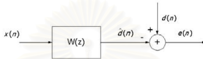
รูปที่ 2.3 การใช้วงจรรองวินเนอร์ในการประมาณสัญญาณที่ต้องการ
