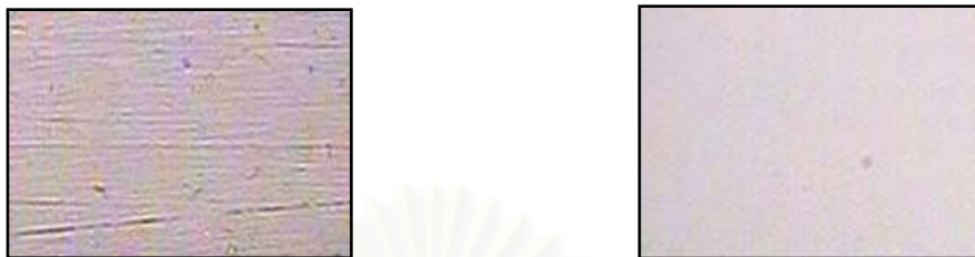
รูปที่ 41 แสดงพื้นผิวเรซินอะคริลิกที่กำลังขยาย 20 เท่า
