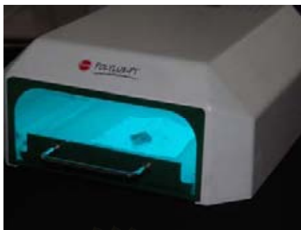
รูปที่ 24 ค. บ่มในตู้อบแสง
