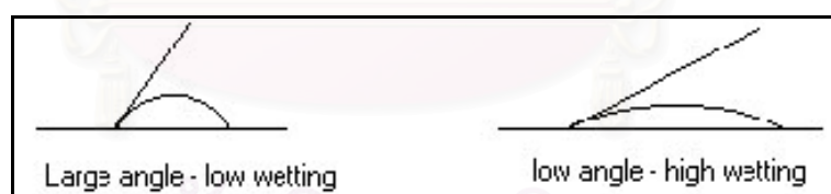
รูปที่ 12 แสดงความชอบน้ำที่พื้นผิว ก. คือมุมสัมผัสมาก ความชอบน้ำต่ำ (Hydrophobic surface) ข. คือมุมสัมผัสน้อย ความชอบน้ำสูง (Hydrophilic surface)
