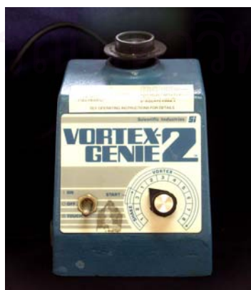
รูปที่ 28 ก. แสดงเครื่องผสมสารให้เข้ากัน (Vortex-Genie 2™)
