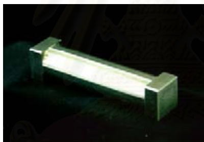
รูปที่ 24 ก. เครื่องปาดสารเคลือบผิว แบ่งตามความหนาในแต่ละด้าน
