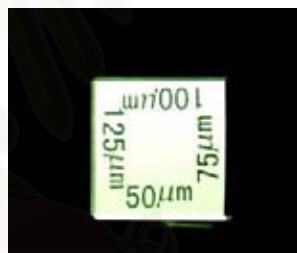
รูปที่ 24 ก. เครื่องปาดสารเคลือบผิว แบ่งตามความหนาในแต่ละด้าน
