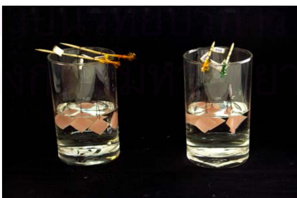
รูปที่ 29 แสดงวิธีแช่สารทำความสะอาดพื้นเทียม
