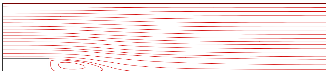
รูปที่ 3.8 Streamline ของการไหลภายใน Backward-facing step สำหรับ Re_H = 36,000
