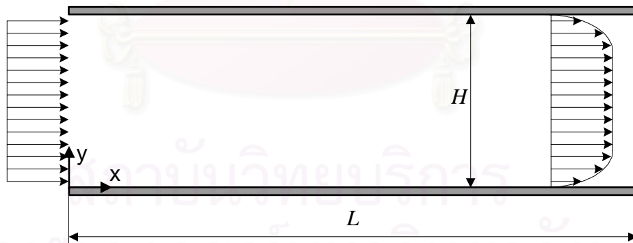
รูปที่ 3.1 ลักษณะของปัญหาการไหลในแผ่นคู่ขนานที่อยู่หนึ่ง
